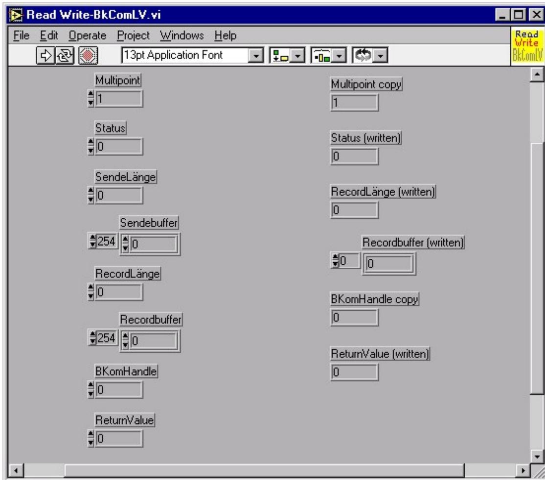
Bei dem Read Write-BkComLV.vi handelt es sich um einen synchronen Kommunikationsaufruf zum Schreiben des gesamten Ausgangs- und Auslesen des gesamten Eingangsprozeßabbildes eines BK8x00 Buskopplers. Die Größe des gelesenen Prozeßabbildes hängt von der Anzahl und Art der gesteckten Klemmen an diesem Koppler ab.
