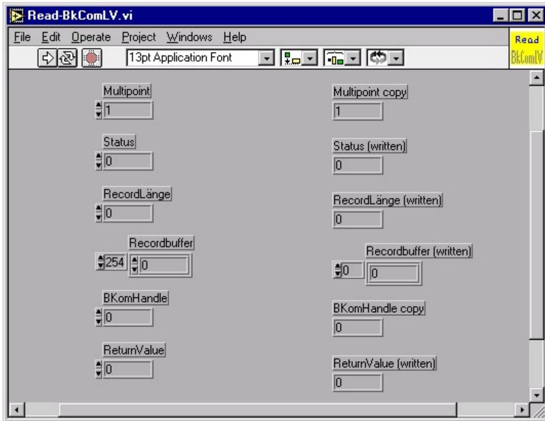
Bei dem Read-BkComLV.vi handelt es sich um einen synchronen Kommunikationsaufruf zum Auslesen des gesamten Eingangsprozessabbildes eines BK8x00 Buskopplers.
