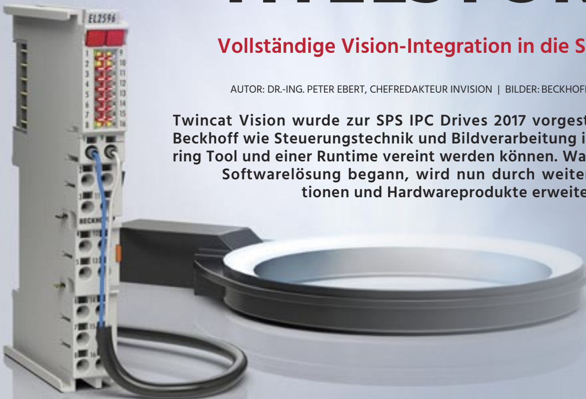
Bild 2 | Die 1-Kanal-LEDAnsteuerungsklemmen der Serie EL2596 ermöglichen Blitzbeleuchtungen mit Pulsen ab 50µs.
