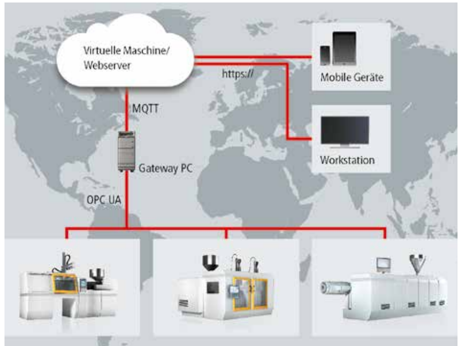
Bild 1. Die Daten der Kunststoffmaschinen werden per OPC UA in einen Gateway-PC übertragen, der per MQTT mit einer Cloud kommuniziert. Dort werden die Daten aggregiert und mithilfe von Analyseprogrammen aufbereitet, die in einer virtuellen Maschine ausgeführt werden. Der autorisierte Nutzer kann von jedem Gerät mit Browserfunktion auf seine Maschinendaten in der Cloud zugreifen (© Beckhoff)
