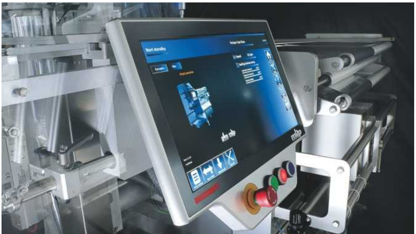
Das Steuerungskonzept der Folienspule ermöglicht eine deutlich kompaktere Bauform der Maschine: Die bewegliche, dreieckige Folienwende- vorrichtung reduziert die Anzahl an Kalandervalzen und somit den Platzbedarf. Gleichzeitig steigt die Dynamik.
