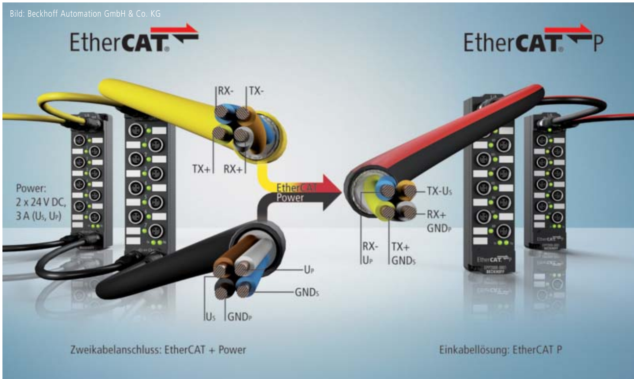
Ethercat P (rechts) kombiniert auf einem 4-adrigen Standard-Ethernet-Kabel die Ethercat-Kommunikation mit der Leistungsversorgung für die angeschlossenen Verbraucher.
