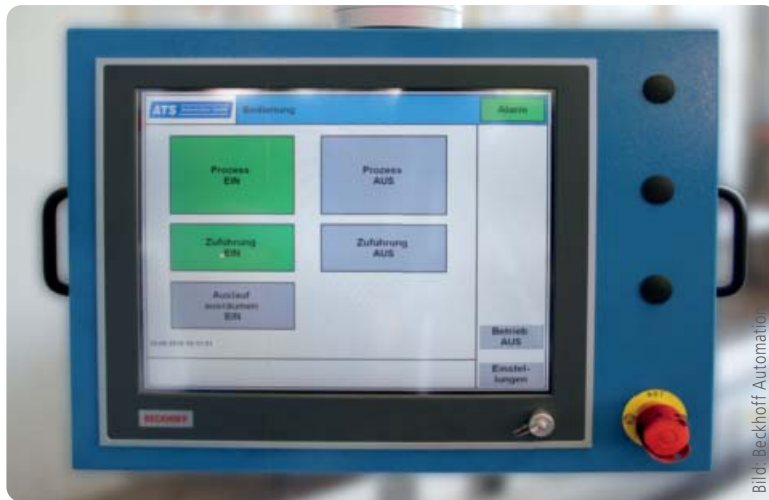
Bild 2: Der 19-Zoll-Touchscreen des Einbau-Panel-PC CP6203 bietet ausreichend Fläche für eine übersichtliche Darstellung der mit TwinCAT HMI erstellten Visualisierung.
