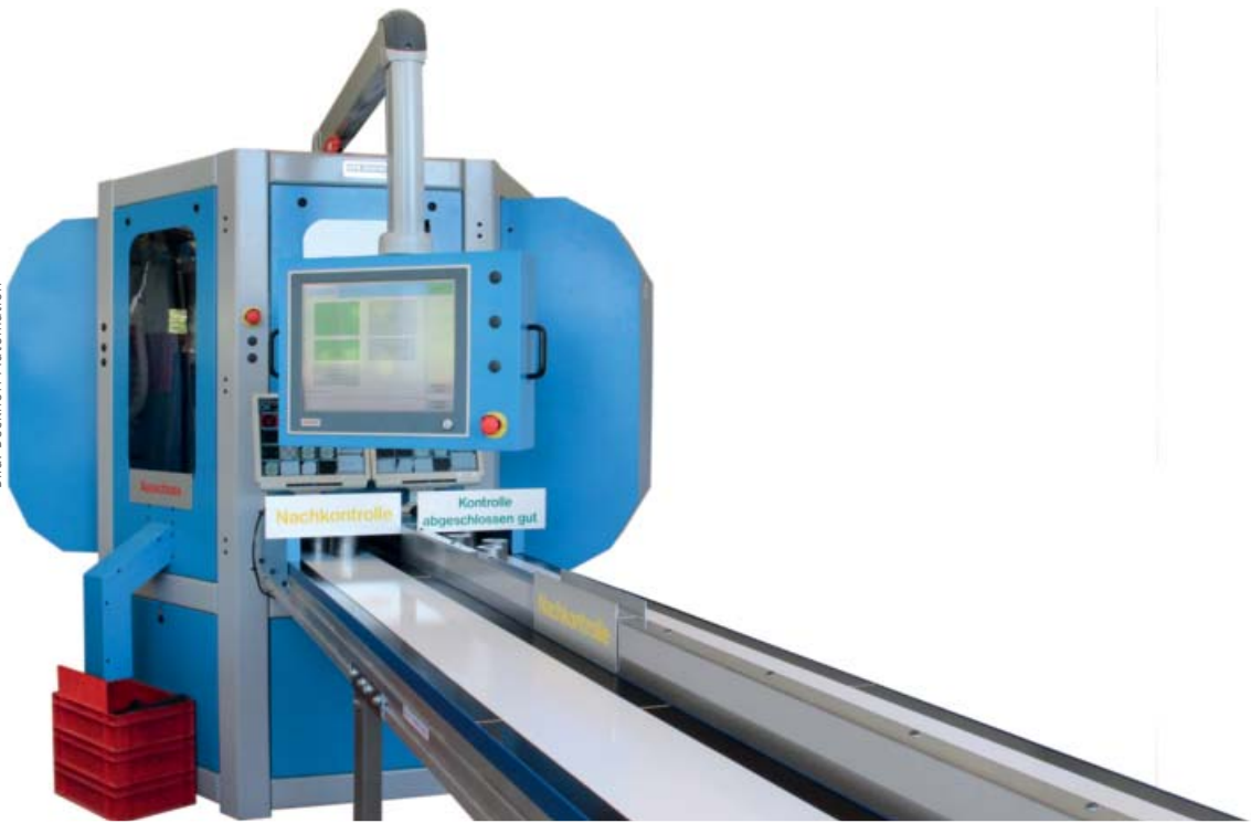
Bild 1: Bei der ATS-Prüfzelle für Brüggli Industrie übernimmt ein Delta-Roboter das komplette Handling der Stanzteile.
