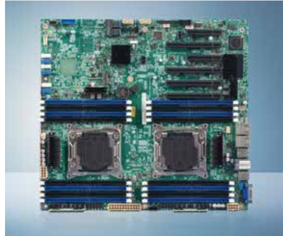
03 Der Industriereserver C6670 enthält schon jetzt zwei Intel-Xeon-Prozessoren mit jeweils 6, 12 oder 18 Cores auf einem Motherboard
