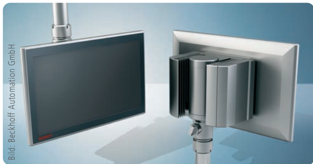
Bild 3: Die für die Tragarmmontage konzipierte Panel-PC-Reihe CP32xx bringt Multitouch und hohe Rechenleistung auf kompakte Weise ins Feld.
