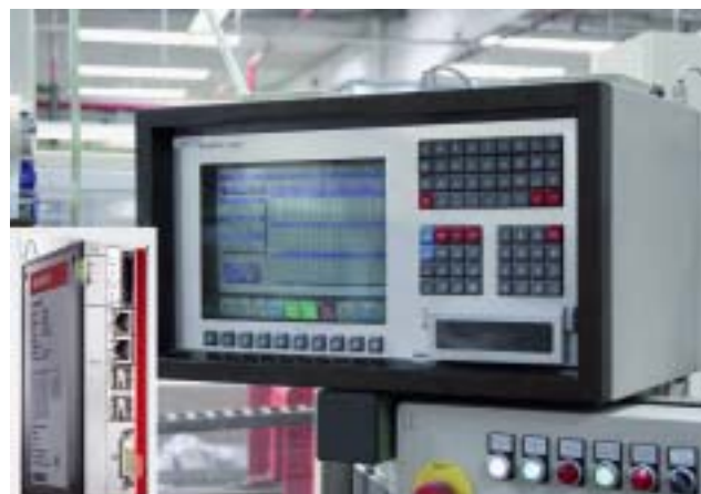
Historische PC-Steuerung C4000 versus moderner Industrie-PC C6915 (links), dem mit 48 x 164 x 116 mm (ohne Montageplatte) kompaktesten Beckhoff-IPC
