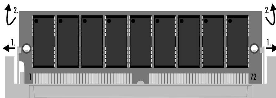
PS2-SIMM-Module lassen sich nur in einer Ausrichtung in den Slot einsetzen. Stecken Sie das Modul mit den Kontaktflächen nach unten in den Slot und drücken Sie es dann soweit herunter, bis die Haltetaschen an den Seiten einrasten. Anhand der in die Bohrungen greifenden Haken können Sie den richtigen Sitz des Moduls prüfen. Die Größe des vorhandenen Speichers erkennt das System beim Einschalten selbstständig.
