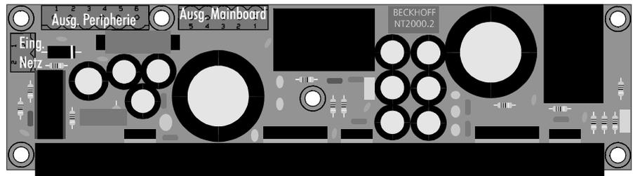
Bei einem BUS mit 24 V DC Netzteil befindet sich an der unteren Gehäusewand des Rechnerkerns die Netzteilplatine, welche die 24 V Eingangsspannung glättet und in die verschiedenen von den IPC Komponenten benötigten Spannungen wandelt.
