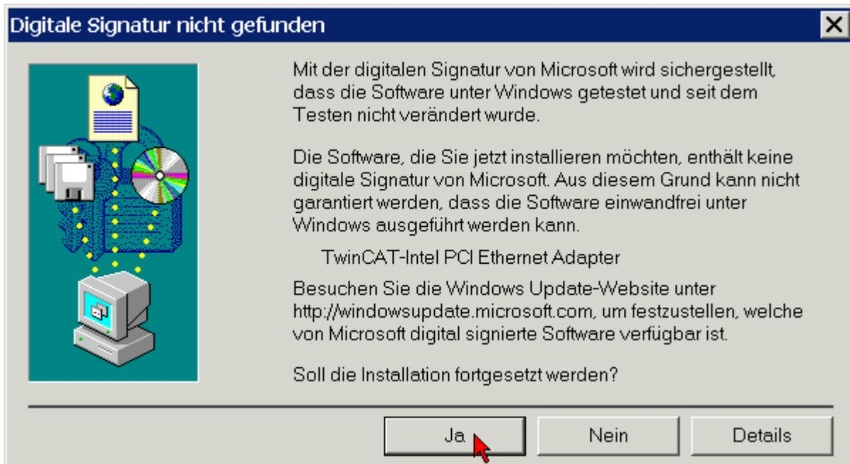
Für den einwandfreien Betrieb des TwinCAT-Treibers für Echtzeit-Ethernet ist keine digitale Signatur von Microsoft erforderlich. Beckhoff hat diesen Treiber in Verbindung mit der unterstützten Hardware gründlich getestet und die Kompatibilität mit Windows-Betriebssystemen überprüft.
