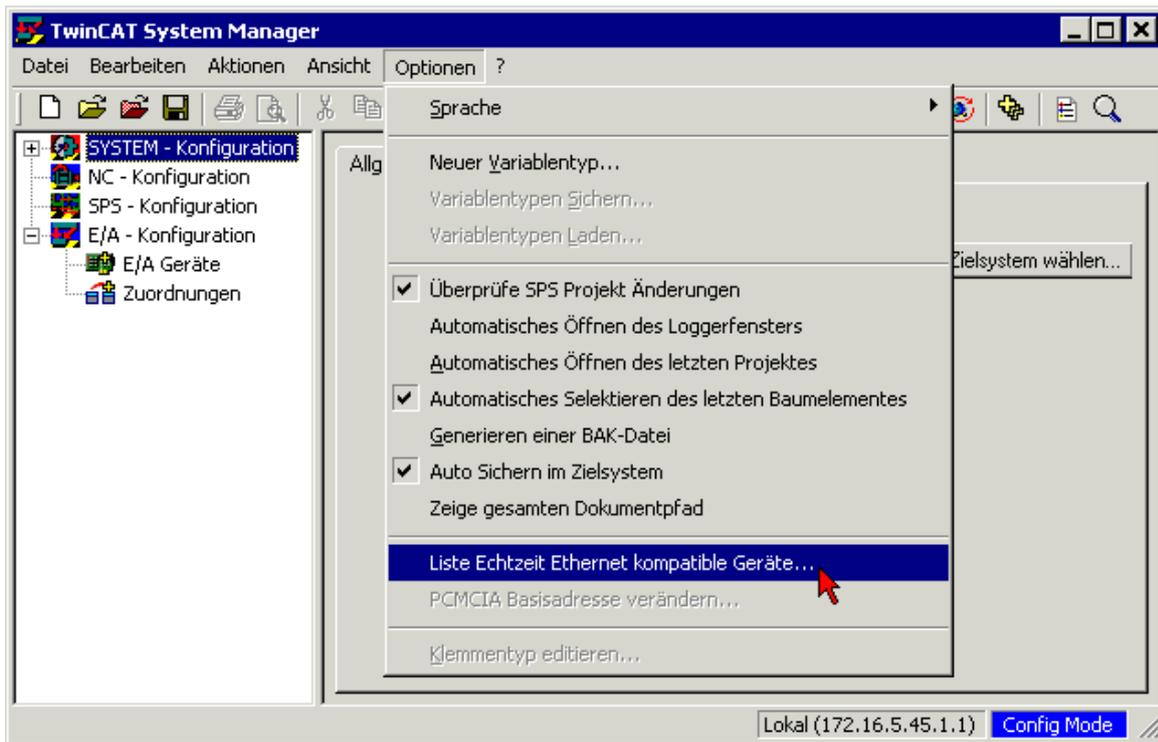
Der TwinCAT System-Manager zeigt nun die echtzeitfähigen (Compatible devices) und nicht echtzeitfähigen (Incompatible devices) Netzwerkadapter an.
