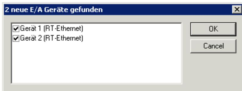
Der System-Manager will nun an den Kanälen der FC9004 nach Boxen (Buskopplern, Busklemmen Controllern oder Feldbus Box Modulen) suchen.
