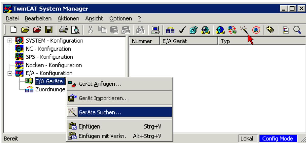
Der System-Manager sucht nun nach im PC eingebauten E/A-Geräten (z.B. Feldbuskarten). Im dargestellten Beispiel werden die Kanäle der FC9004, für die
