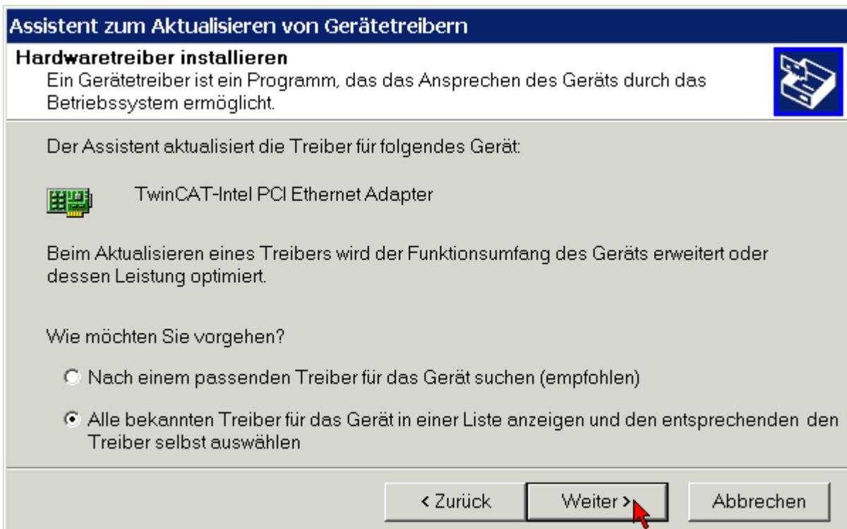
Wenn Sie zuvor die Beckhoff Automatisierungs-Software TwinCAT installiert haben, wird Ihnen der Hardware-Assistent auch den TwinCAT-Treiber für Echtzeit-Ethernet anbieten.
