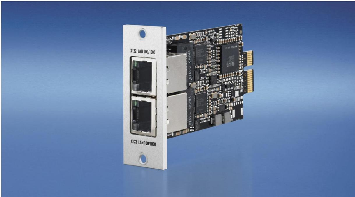
Beckhoff PCIe-Module sind eine neue Definition von hochintegrierten PCI-Express-Steckkarten, die dem Trend zu immer kleiner werdenden PCs gerecht wird. Die Funktion von PC-Steckkarten wird in ein kompaktes Format für die raue Industrieumgebung gebracht.
