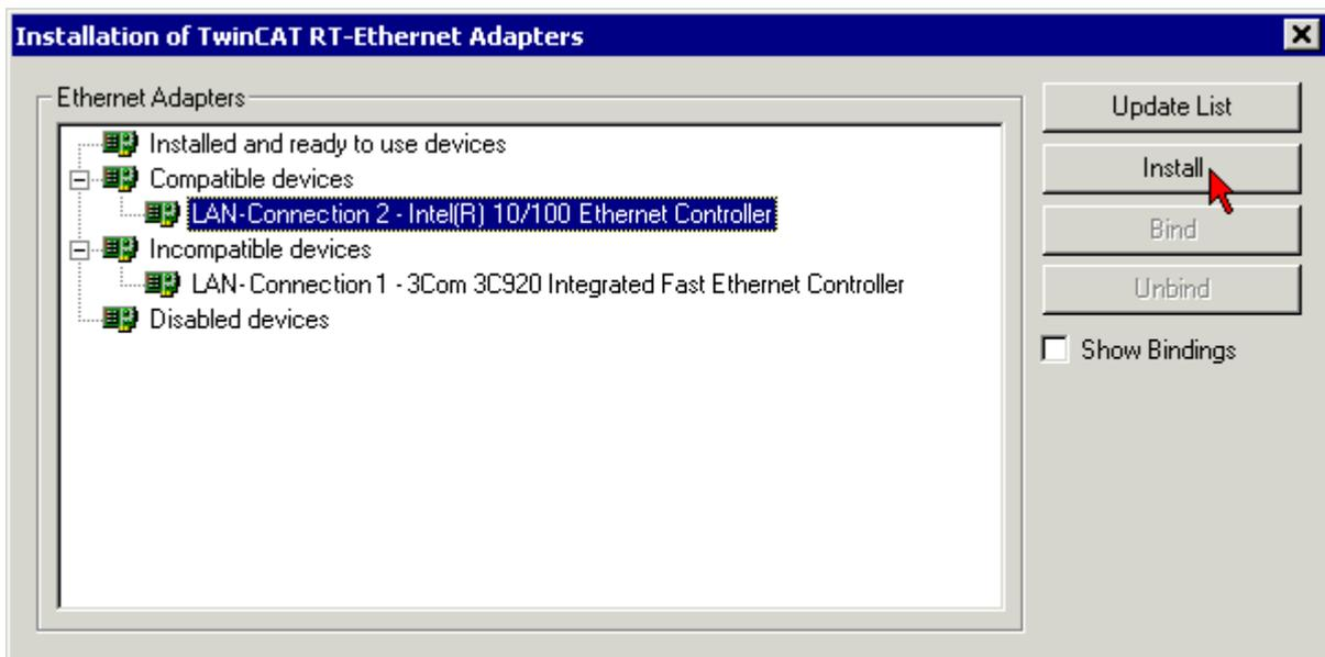
Der TwinCAT System-Manager installiert nun für das Ausgewählte Gerät den TwinCAT-Treiber für Echtzeit-Ethernet und das TwinCAT-Ethernet-Protokoll.
