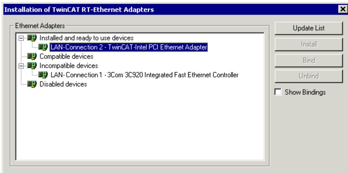
Der TwinCAT-Treiber für Echtzeit-Ethernet und das zugehörige TwinCAT-Ethernet-Protokoll wurden installiert.
