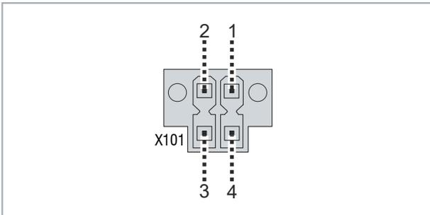
Abb. 5: Spannungsbuchse Pin-Nummerierung
