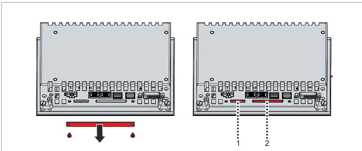
Abb. 23: Zugang Batterie und Speichermedium
