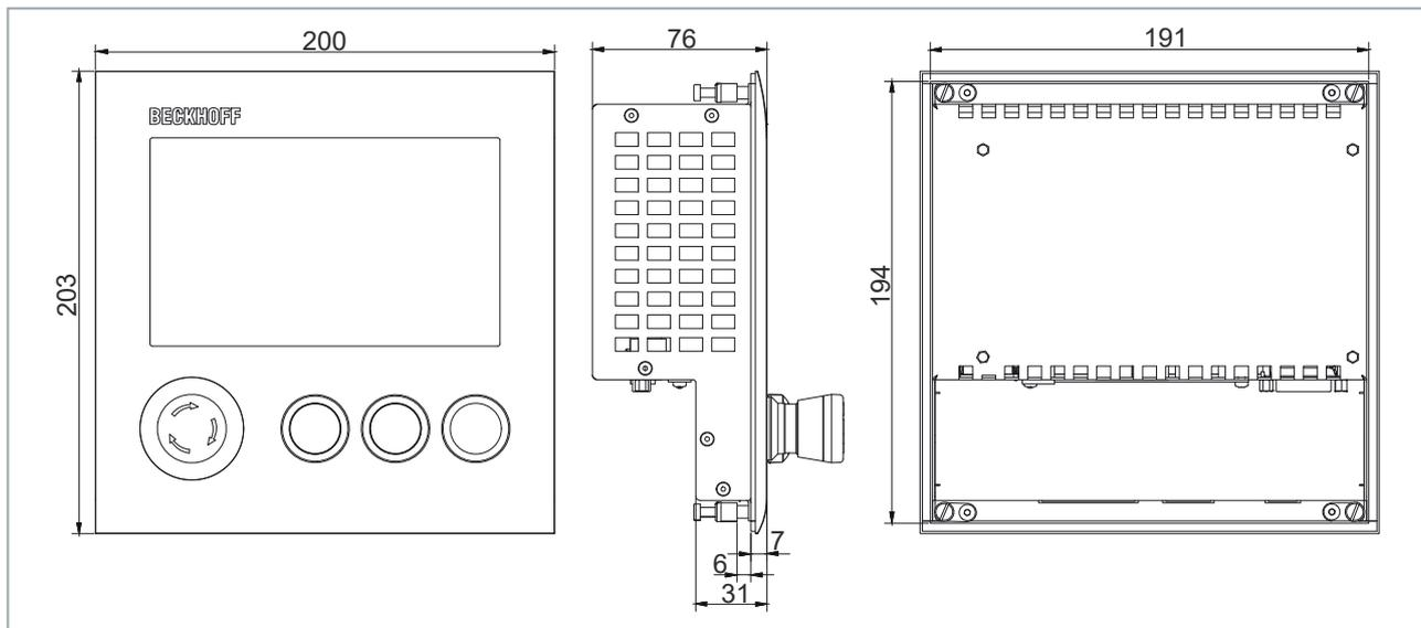
Abb. 13: Abmessungen Tastererweiterung
