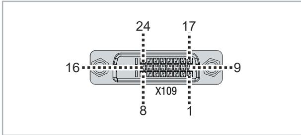
Abb. 8: DVI-Schnittstelle Pin-Nummerierung
