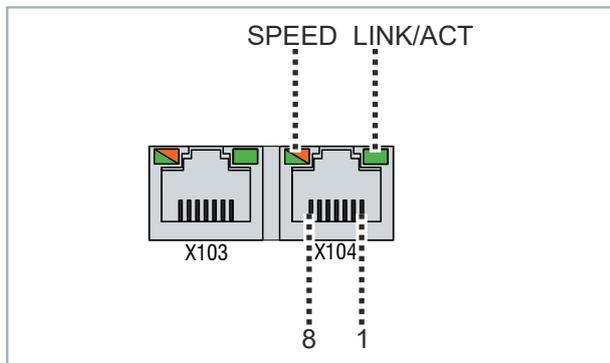
Abb. 6: Ethernet-Schnittstelle Pin-Nummerierung
