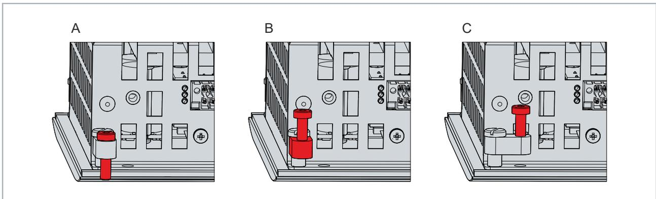
Abb. 20: Demontage aus dem Schaltschrank
