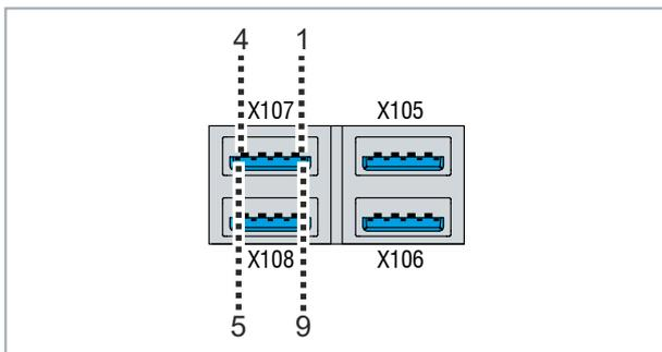
Abb. 7: USB-Schnittstelle Pin-Nummerierung
