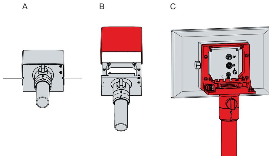
附图 24: 安装支架臂适配器
