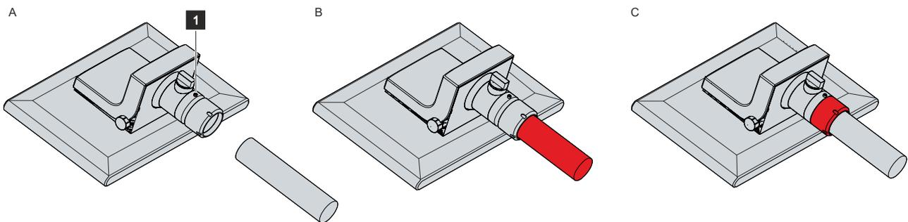
附图 26：支架臂管的安装
