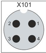
附图 11: 电压插座针脚编号
