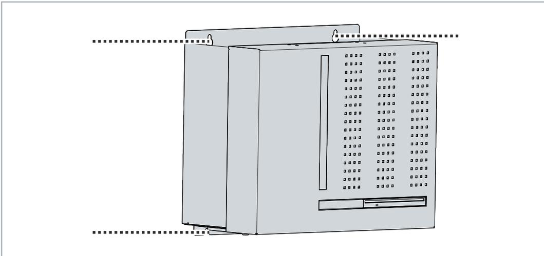
Abb. 23: Position Befestigungsschrauben
