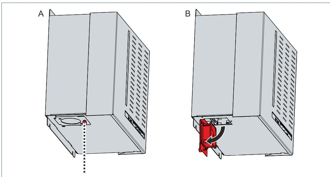
Abb. 33: Lösen Lüfterkassette
