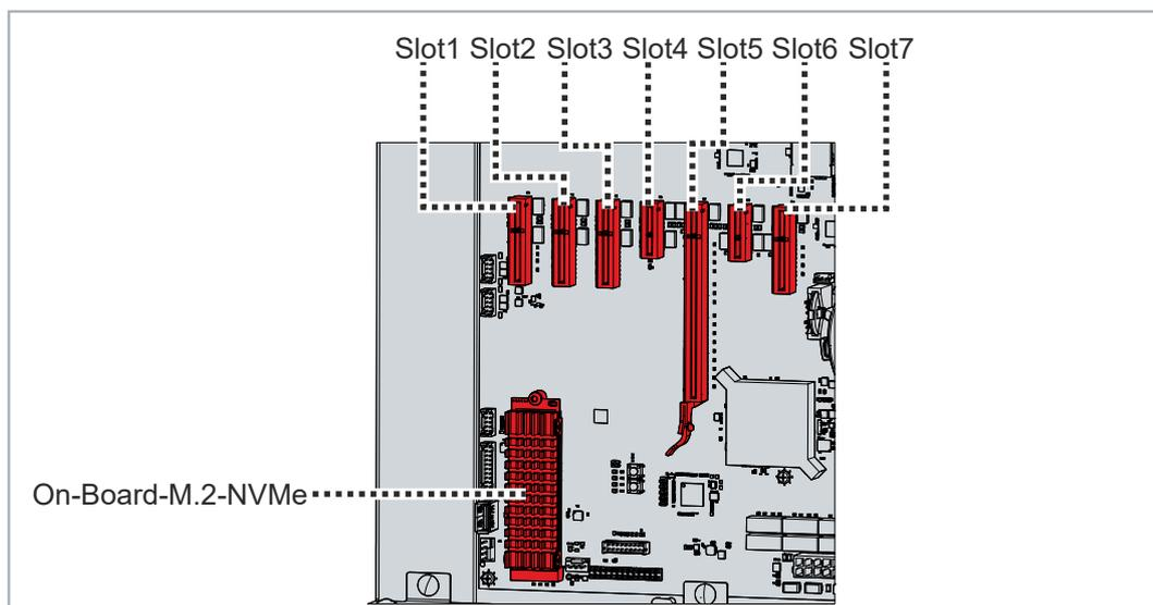
Abb. 30: Nummerierung PCIe®-Steckkartenslots
