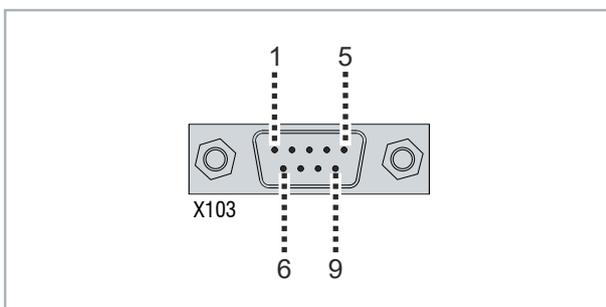
Abb. 9: RS232-Schnittstelle Pin-Nummerierung
