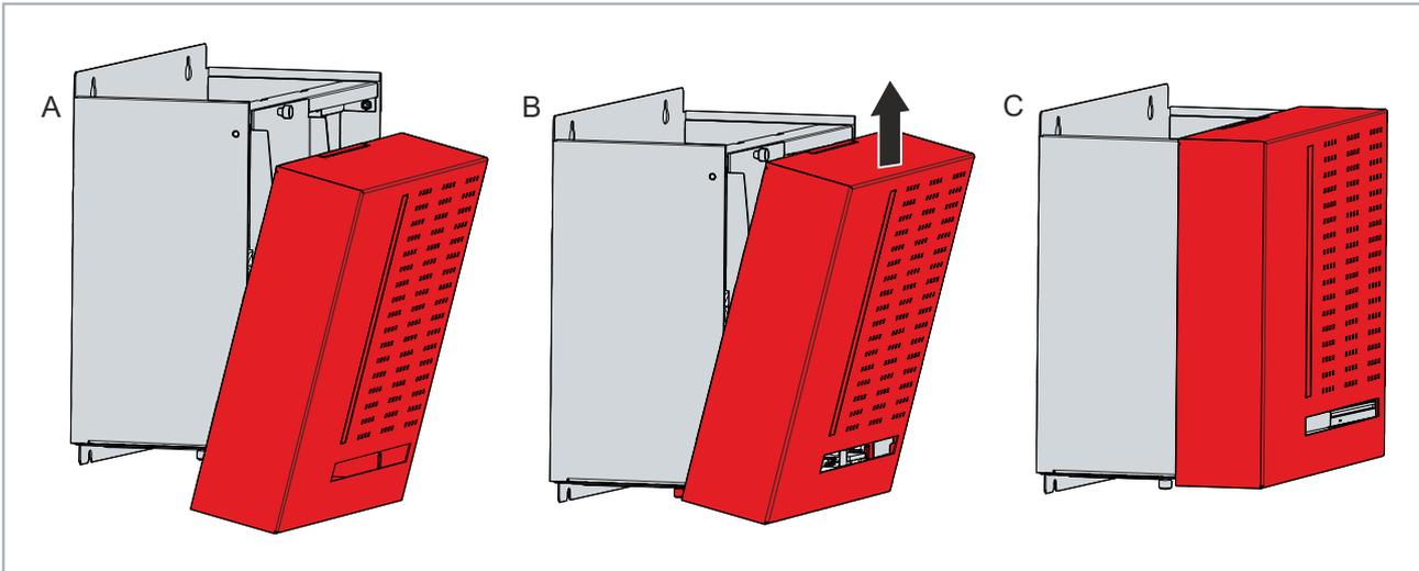
Abb. 28: Montage Gehäusedeckel
