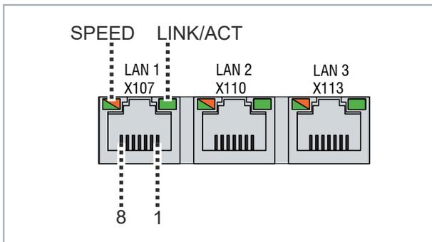
Abb. 7: Ethernet-Schnittstelle Pin-Nummerierung
