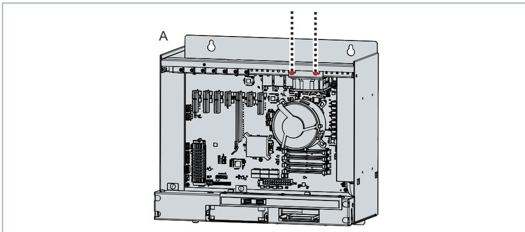
Abb. 35: Lösen Lüfterhalter
