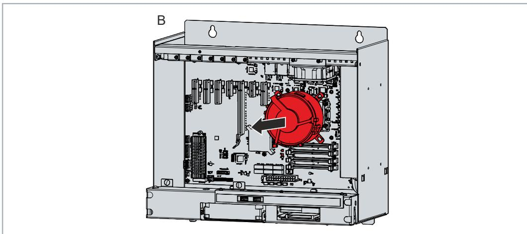
Abb. 38: Entnahme CPU-Kühler
