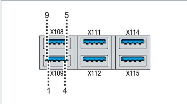
Abb. 6: USB-Schnittstelle Pin-Nummerierung
