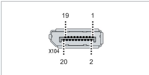
Abb. 10: DisplayPort Pin-Nummerierung
