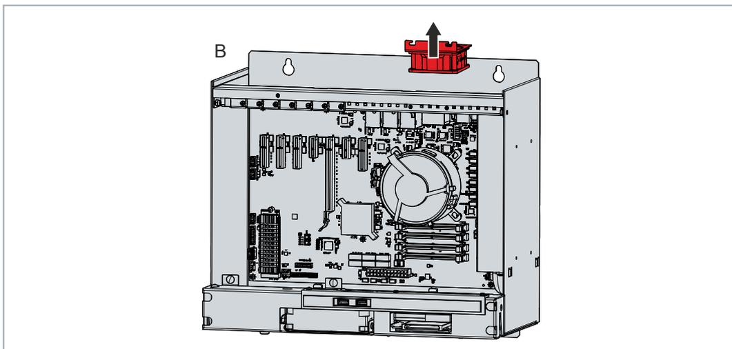
Abb. 36: Entfernen Lüfterhalter mit Lüfter
