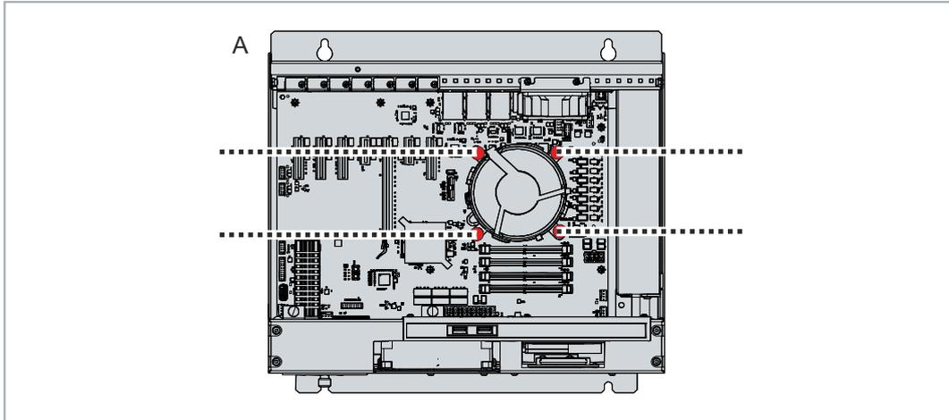
Abb. 37: Entriegelung CPU-Kühler
