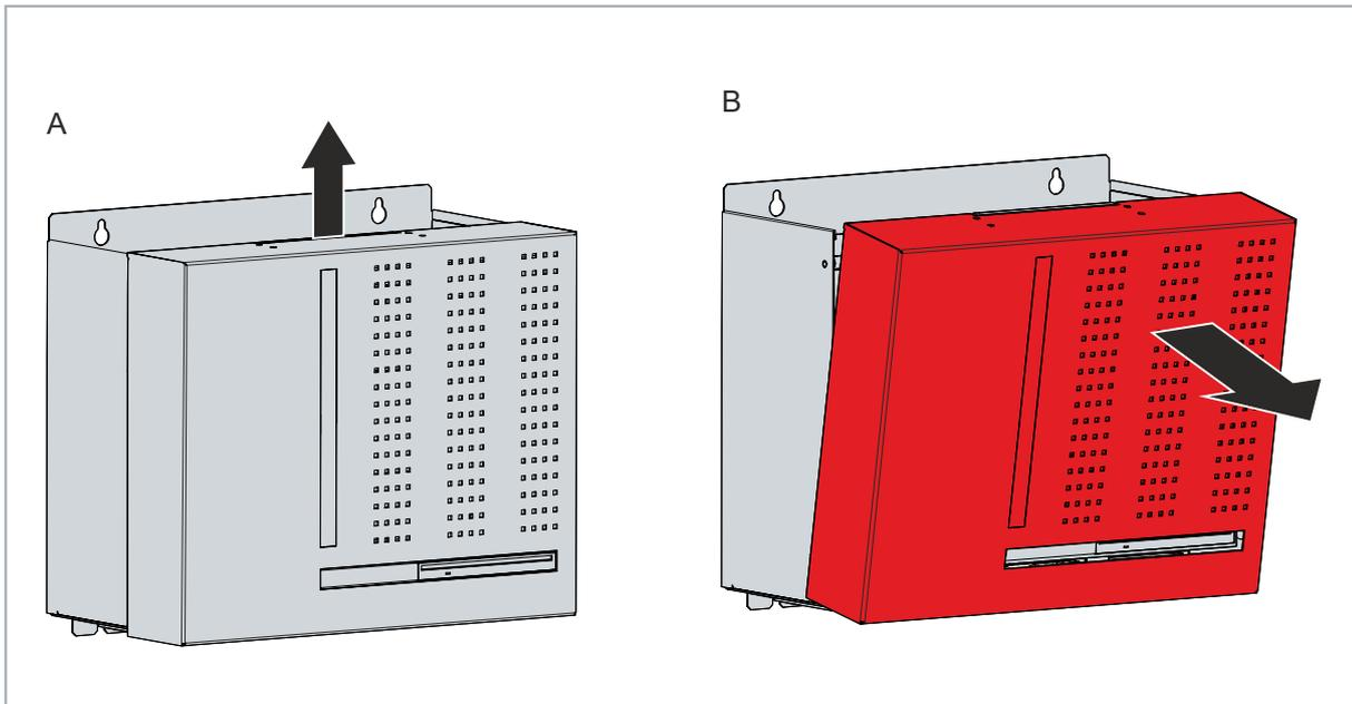
Abb. 24: Entriegelung Gehäusedeckel
