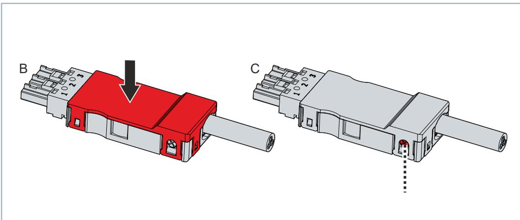
Abb. 18: Zulentlastungsgehäuse schließen
