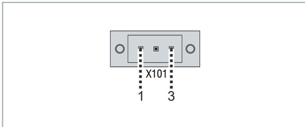
Abb. 4: Spannungsbuchse Pin-Nummerierung
