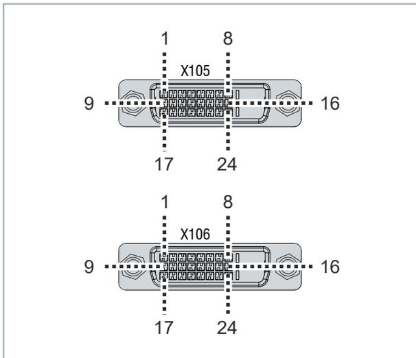
Abb. 8: DVI-Schnittstelle Pin-Nummerierung
