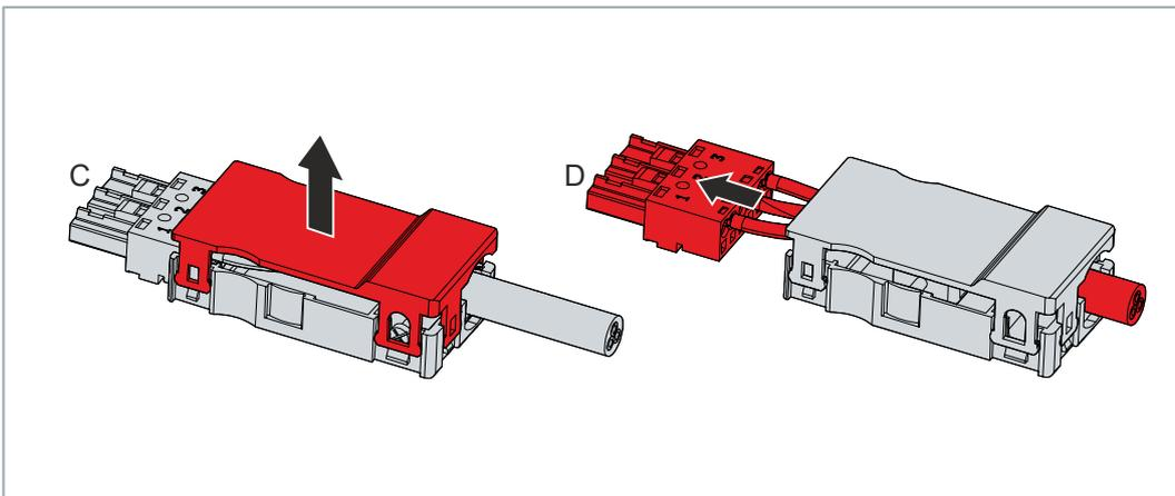
Abb. 20: Zugentlastungsgehäuse entfernen
