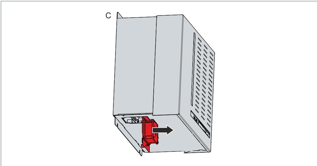
Abb. 34: Entnahme Lüfterkassette
