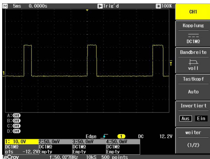
Abb. 50: Verkürzter Puls eines digitalen Ausgangs mit Last.
