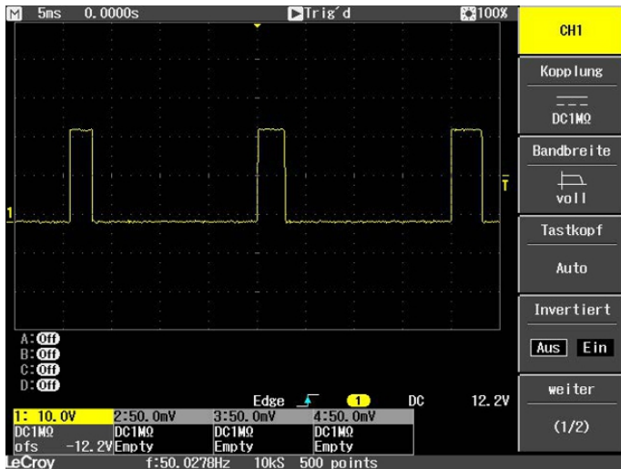
附图 39：带负载的数字量输出的脉冲时间缩短。
