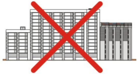
ungültige Installationslage invalid position
