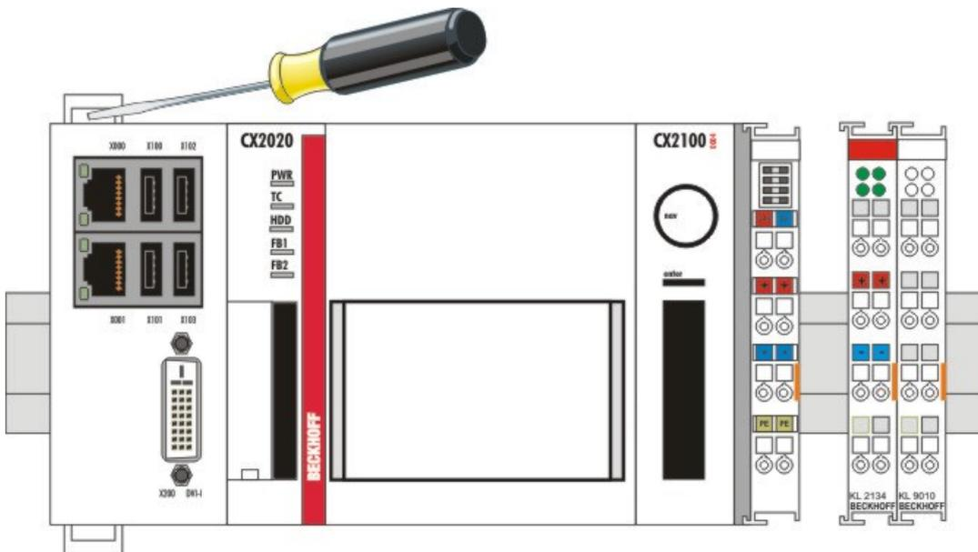
Nach dem Ziehen an der Klemmenentriegelung der Stromversorgung (siehe Pfeil) lässt sich der Block **vorsichtig** von der Hutschiene nehmen.
