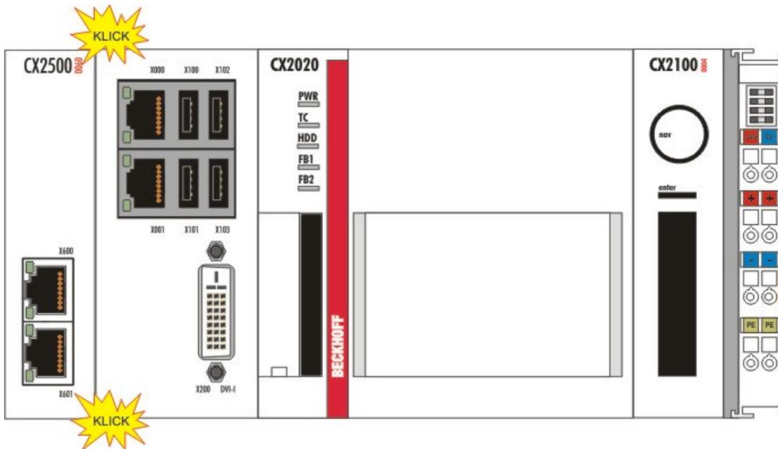
Weitere Module werden in der gleichen Weise mit dem System verbunden. Sind alle Module mit dem System verbunden, können Sie das System als Block auf die Hutschiene setzen. Details hierzu stehen im Kapitel Tragschienenmontage.
