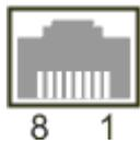
Abb. 2: Ethernet-Schnittstelle, PIN-Nummerierung.
