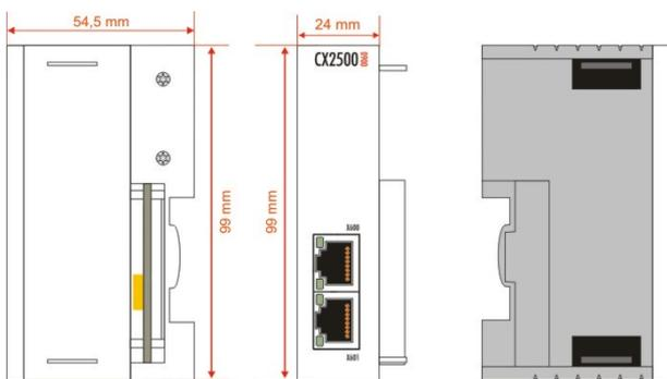
Die Systemschnittstelle CX2500-0060 erweitert eine Steuerung CX20x0 um zwei weitere Gigabit-Ethernet Schnittstellen.
