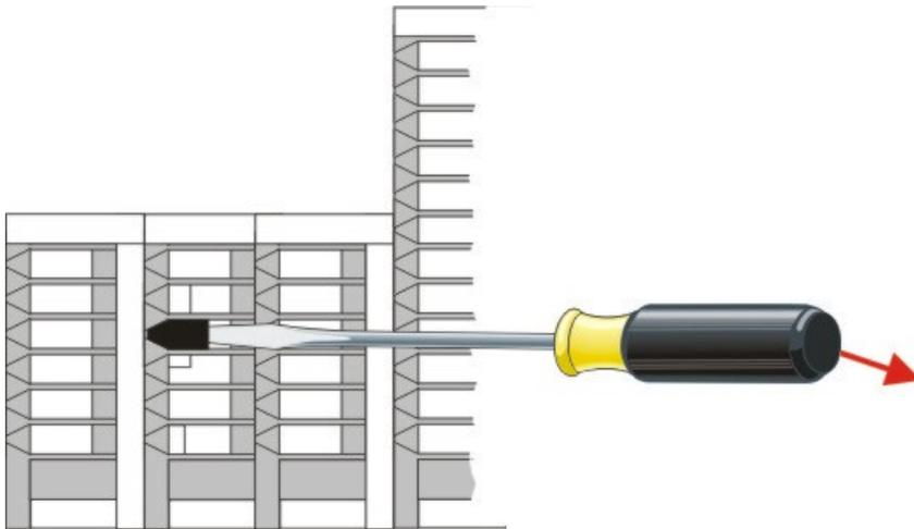
Sind die Riegelclips angehoben können sie herausgezogen werden. Anschließend können die Systemschnittstellen wieder getrennt werden.
