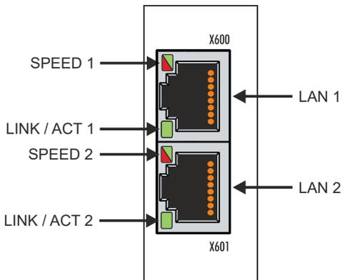
Abb. 1: Ethernet-Schnittstelle X600, X601.
