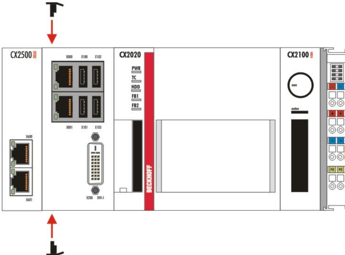
Die Riegelclips werden auf der Ober- und Unterseite eingesteckt:
