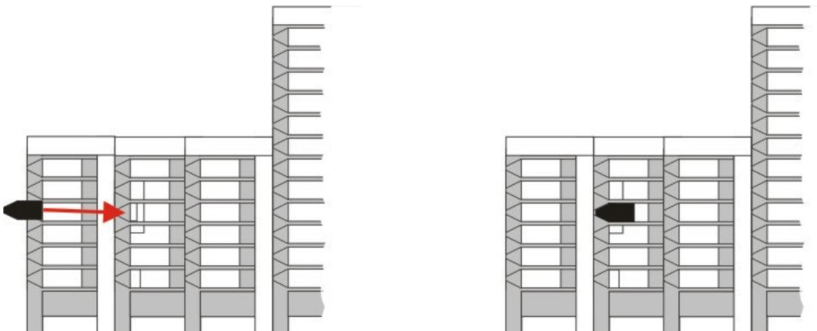
Sind alle Systemschnittstellen verriegelt, so kann die gesamte Baugruppe auf die Tragschiene aufgerastet werden.
