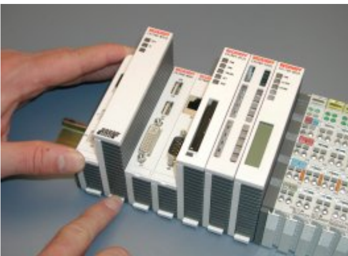
BILD3: Zusammenstecken der Module
