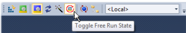
Abb. 92: TwinCAT kann auch durch einen Button in diesen Zustand versetzt werden (TwinCAT 3)
