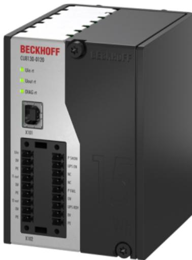
CU8130-0xxx sind batteriegestützte, unterbrechungsfreie Stromversorgungen (USV). Bei Wegfall der externen 24-V-DC-Eingangsspannung übernimmt diese USV die Versorgung der an sie angeschlossenen Geräte dank ihrer geregelten und gepufferten 24-V-DC-Ausgangsspannung.
