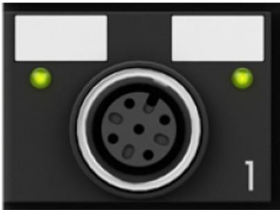
Abb. 7: IO-Link-Anschluss, Master
