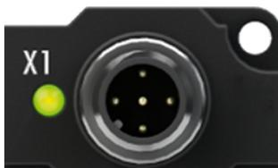
IO-Link Device Status LED (schmales Gehäuse)
