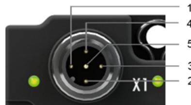
IO-Link-Anschluss, Device (breites Gehäuse)
