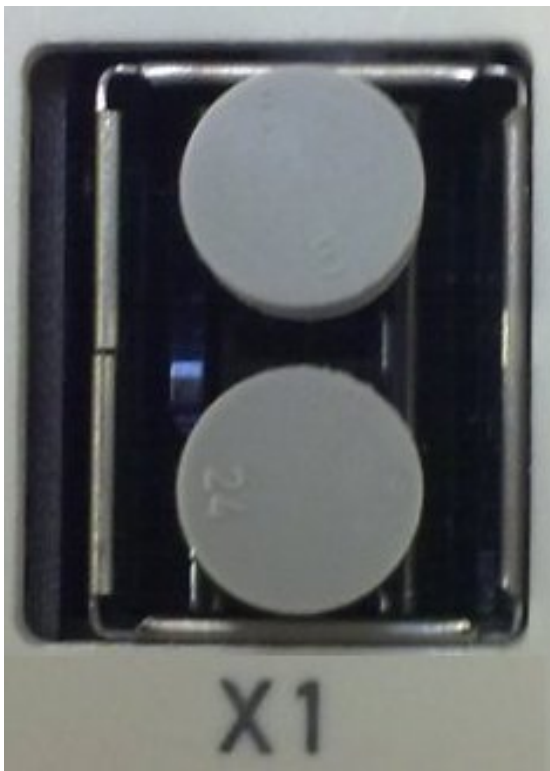
Abb. 32: Blindstopfen in nicht verwendeten Anschlussbuchsen
