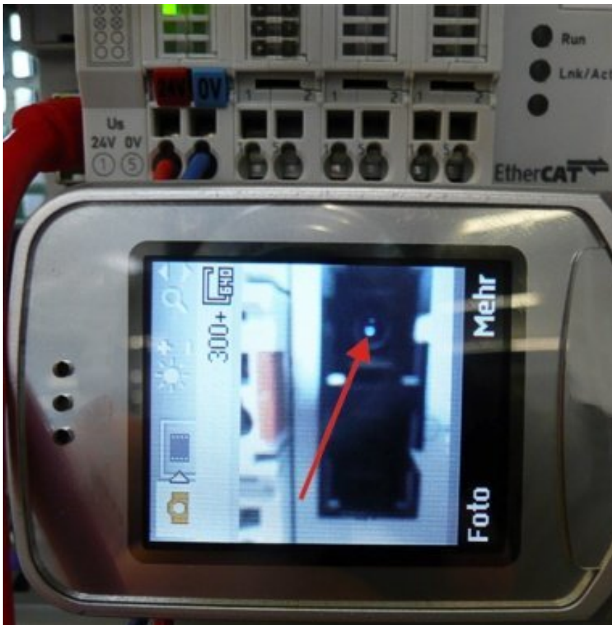
Abb. 28: Visualisierung von infrarotem Licht am SC Duplex Stecker
