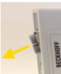
Abb. 24: Schräger Einbau der LWL-Buchse
