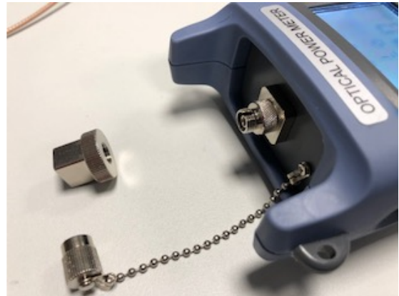
OPM mit aufgeschraubtem FC Adapter
