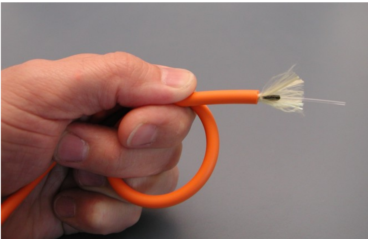
Fixierung der IP-Link-Leitung zur Abisolierung
