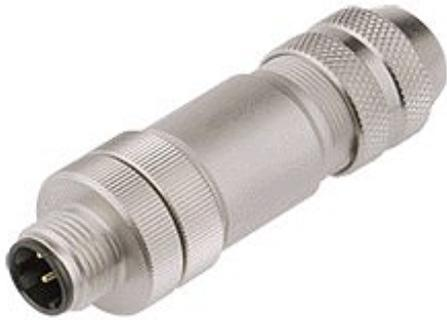
Abb. 25: M12-Stecker, 4-polig, IP67, feldkonfektionierbar, d-codiert
