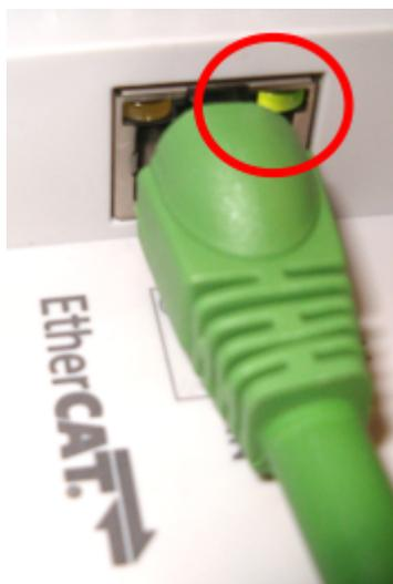
Abb. 33: Link-LED an Ethernet-Geräten
