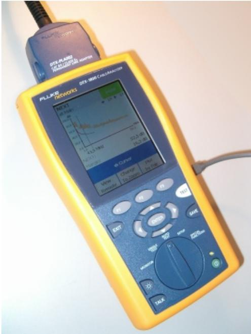
Abb. 3: Kabelzertifizierer, beispielhafte Darstellung
