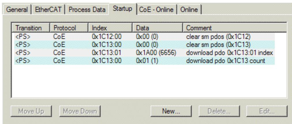
Fig. 115: "Startup" tab
