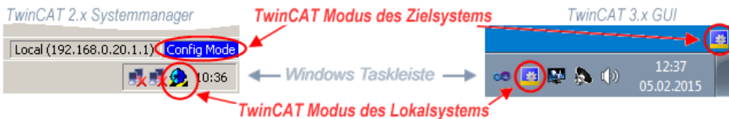
Abb. 89: Unterscheidung Lokalsystem/ Zielsystem (links: TwinCAT 2; rechts: TwinCAT 3)
