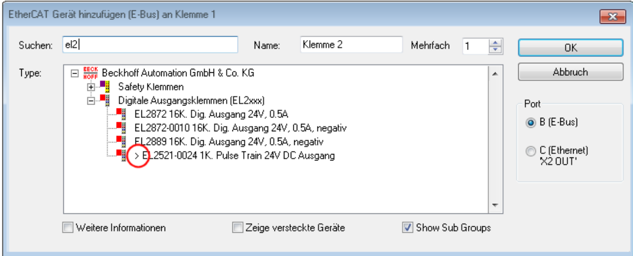
Abb. 75: Kennzeichnung einer online erfassten ESI am Beispiel EL2521
