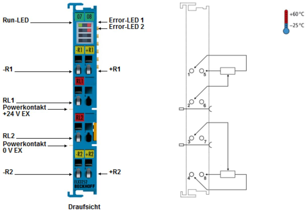
Abb. 20: ELX3252 - Anschlussbelegung
