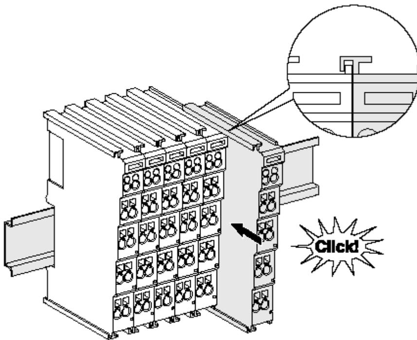
附图 18: 安装在安装轨道上
