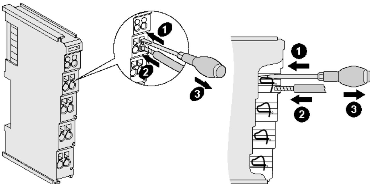
附图 22: 在一个接线点上连接电缆
