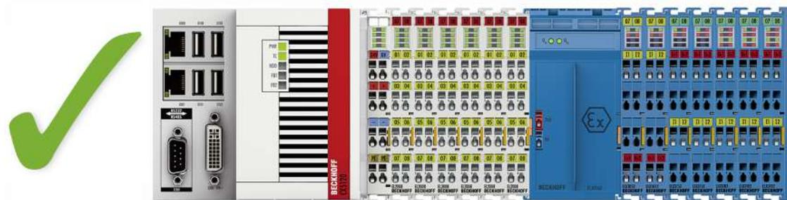
附图 8: ELX 端子模块的允许安装（右侧端子模块）。
