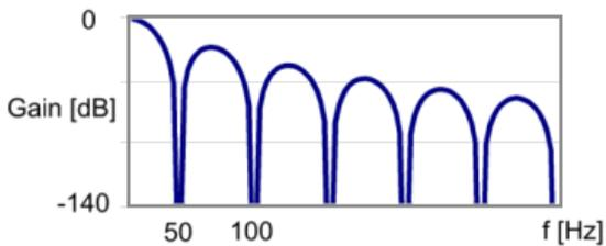
附图 36: 陷波滤波器的典型频率响应设置为50 Hz
