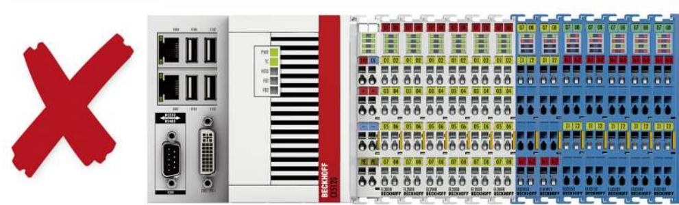
附图 13: 非法的安装 - 缺少 ELX9560 电源端子模块。
