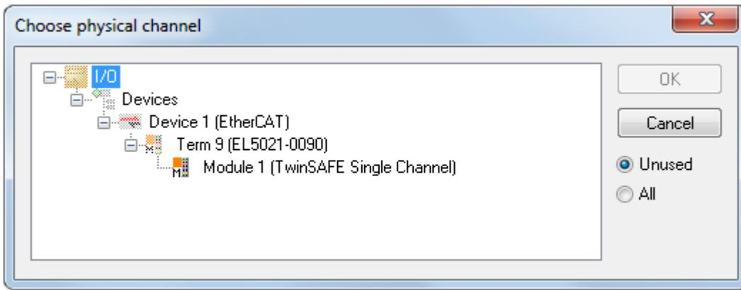
附图 41: 创建一个与TwinSAFE SC终端的连接
