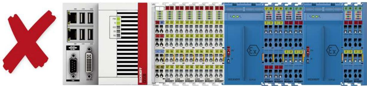
附图 15: 不允许的安装 - ELX 端子模块网段中的第二个 ELX9560 电源端子模块没有前端的 ELX9410。
