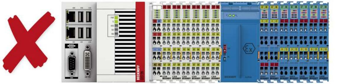
附图 16: 非法的安装 - 缺少 ELX9012 总线终端盖板。
