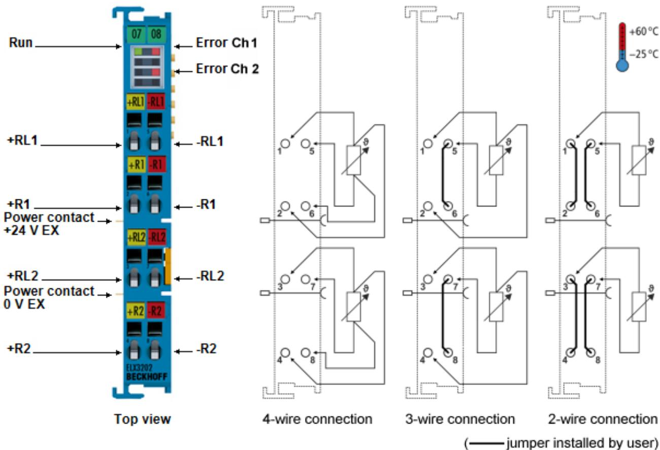
附图 6: ELX3202 - 用于2线、3线和4线连接的2通道模拟输入终端热电阻，16位，Ex i
