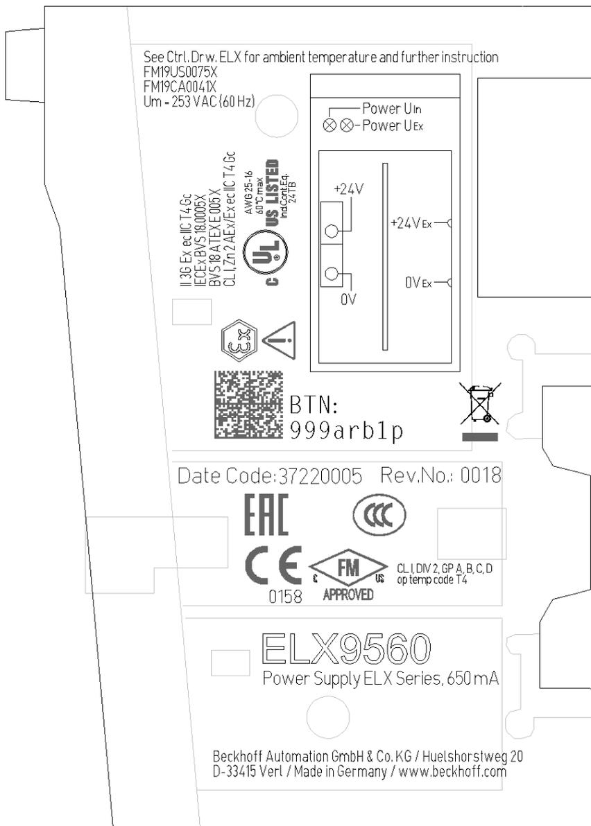
Abb. 2: ELX9560-0000 mit Date Code 37220005, BTN 999arb1p und Ex-Kennzeichnung
