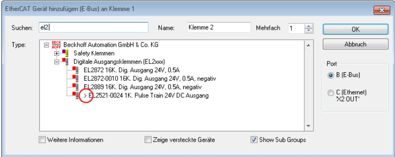
Abb. 86: Kennzeichnung einer online erfassten ESI am Beispiel EL2521
