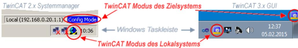
Abb. 91: Unterscheidung Lokalsystem/ Zielsystem (links: TwinCAT 2; rechts: TwinCAT 3)
