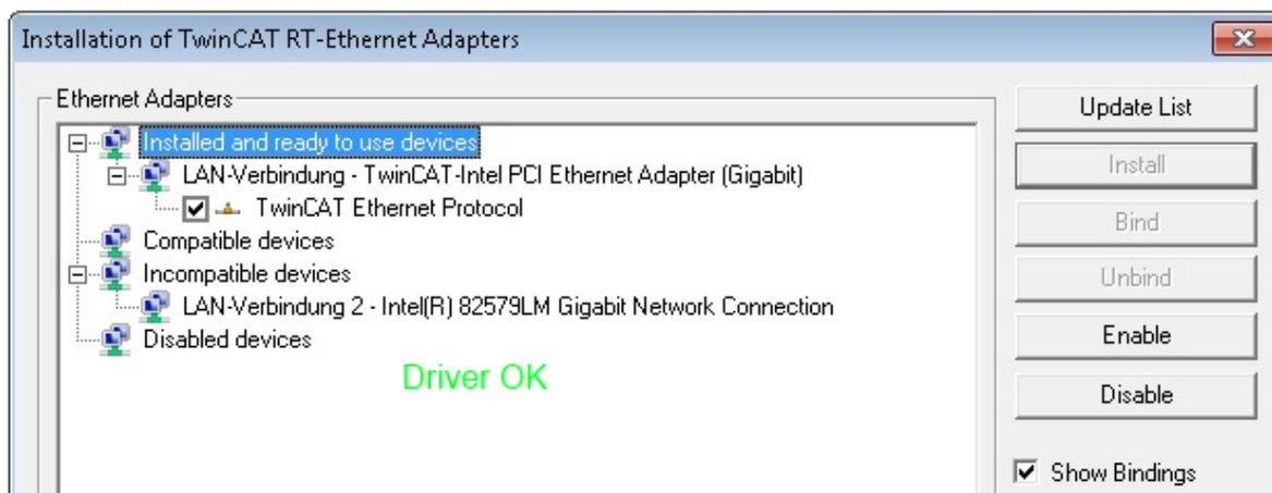
Abb. 70: Beispielhafte korrekte Treiber-Einstellung des Ethernet Ports
