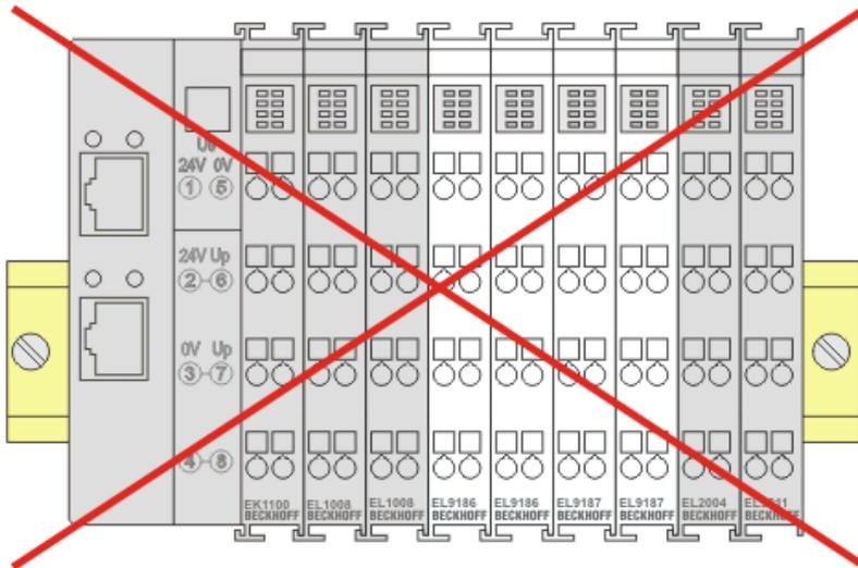
Abb. 19: Inkorrekte Positionierung
