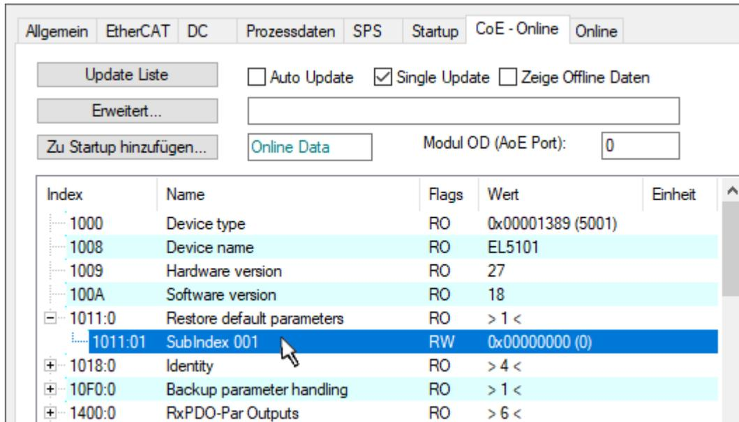
Abb. 112: Auswahl des PDO *Restore default parameters*
