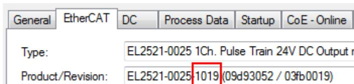
Abb. 58: Erkennen EtherCAT-Klemme mit Revision -1019
