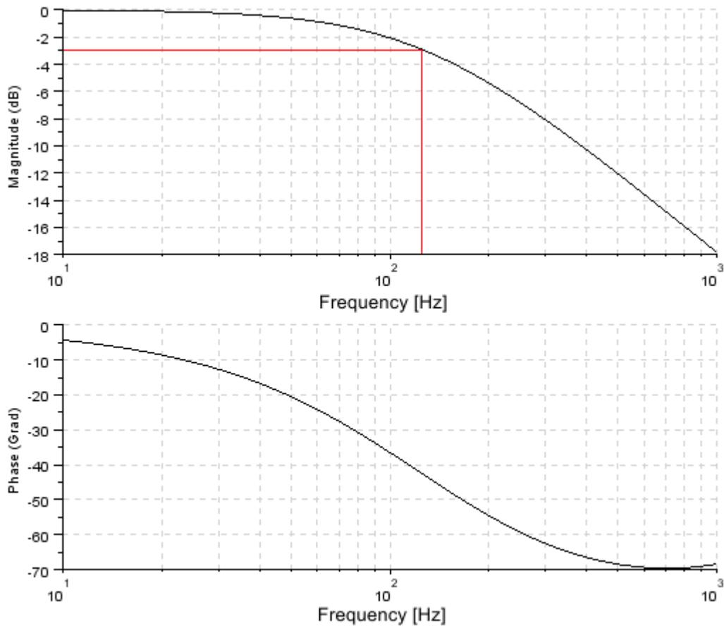
Abb. 96: Bodediagramm der IIR-Filter
