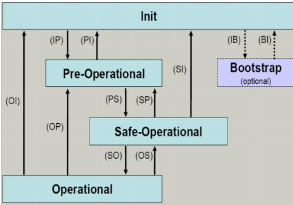
Abb. 7: Zustände der EtherCAT State Machine
