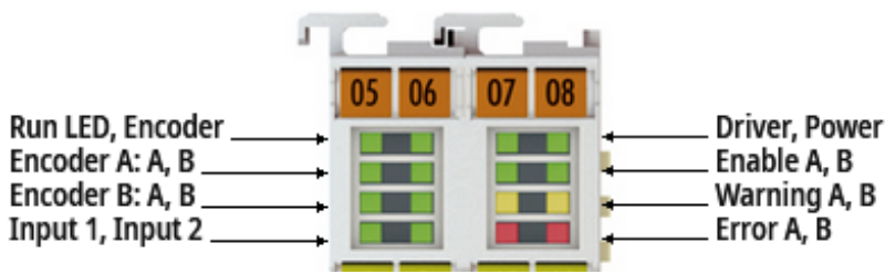
Fig. 32: EL7342 - LEDs
