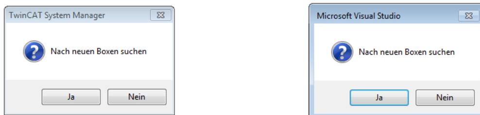
Abb. 63: Scan-Abfrage nach automatischem Anlegen eines EtherCAT-Gerätes (links: TC2; rechts TC3)
