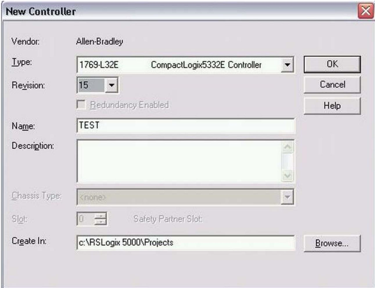
Abb. 138: Erstellen eines neuen Controlllers
