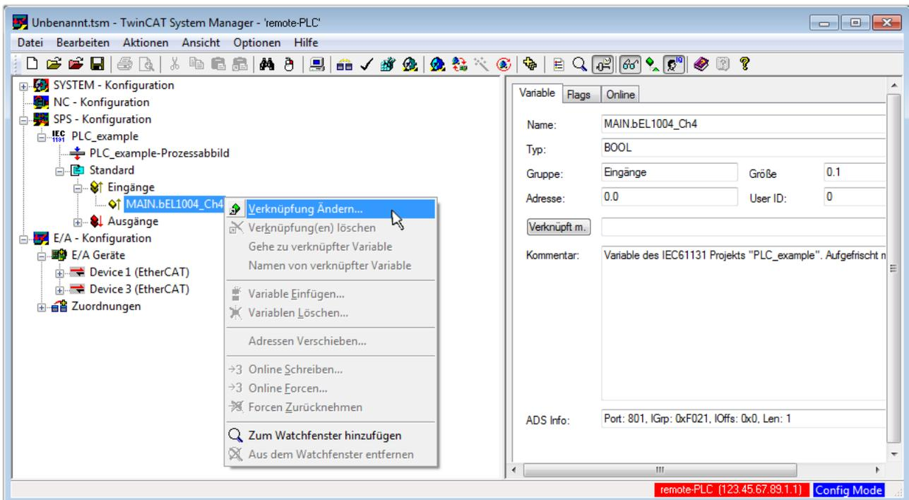
Abb. 29: Erstellen der Verknüpfungen PLC-Variablen zu Prozessobjekten
