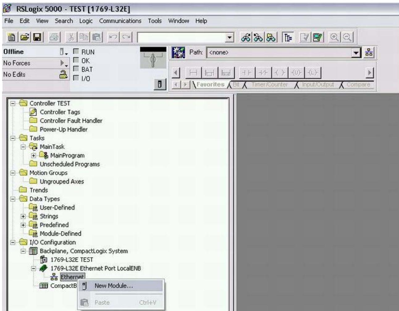
Abb. 139: Anfügen eines neuen Moduls
