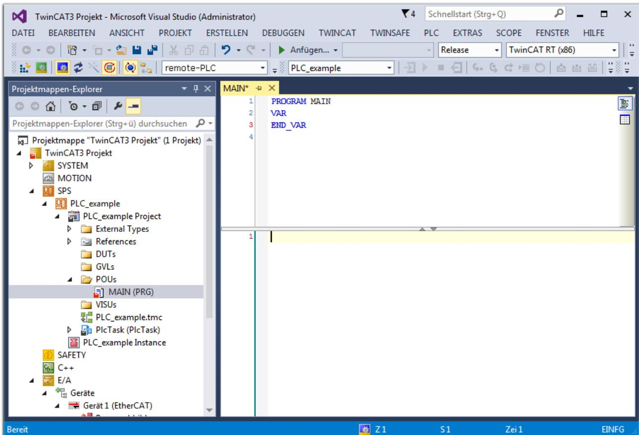
Abb. 46: Initiales Programm „Main“ des Standard PLC Projektes
