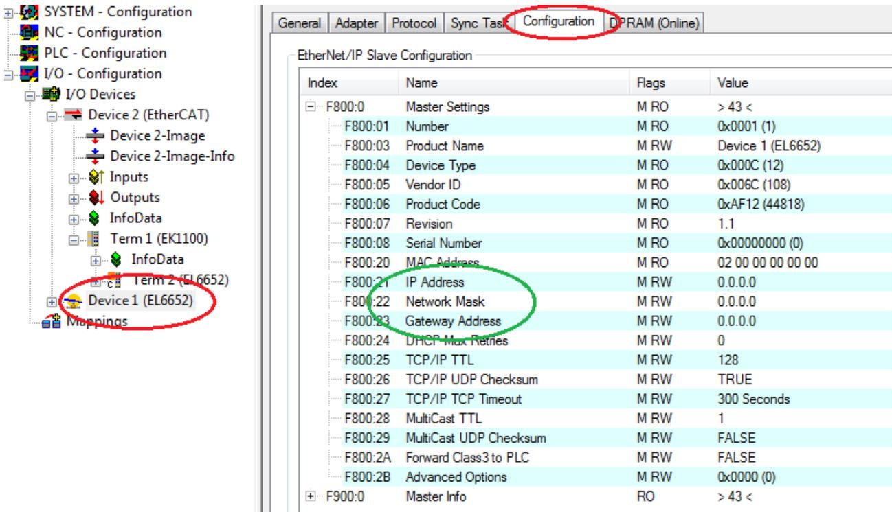
Abb. 122: Konfiguration der IP-Adresse, Netzwerk-Maske und Gateway-Adresse
