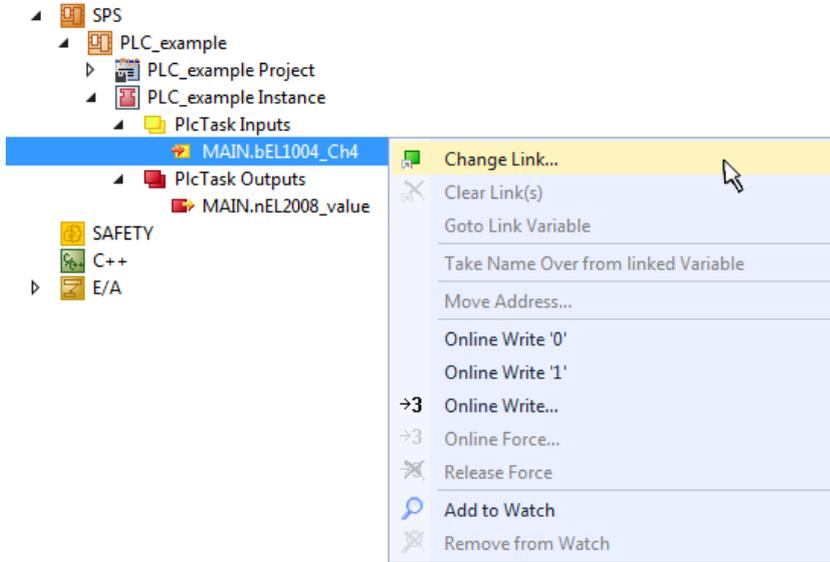
Abb. 49: Erstellen der Verknüpfungen PLC-Variablen zu Prozessobjekten
