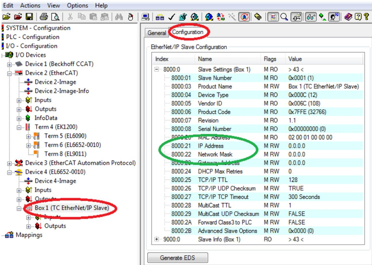
Abb. 133: Konfiguration der IP-Adresse, Netzwerk-Maske
