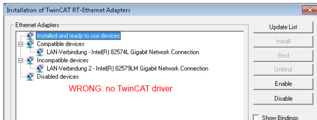
附图 52: 以太网端口驱动程序的错误设置
