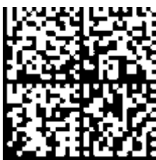
Fig. 3: Example DMC 1P 072222 SBTN k4p562d7 1K EL1809 Q 1 51S 678294
