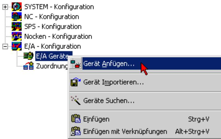
Abb. 162: Anfügen eines neuen E/A-Gerätes (E/A-Geräte -> Rechte Maustaste -> Gerät anfügen...)
