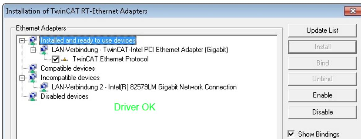
Abb. 71: Beispielhafte korrekte Treiber-Einstellung des Ethernet Ports
