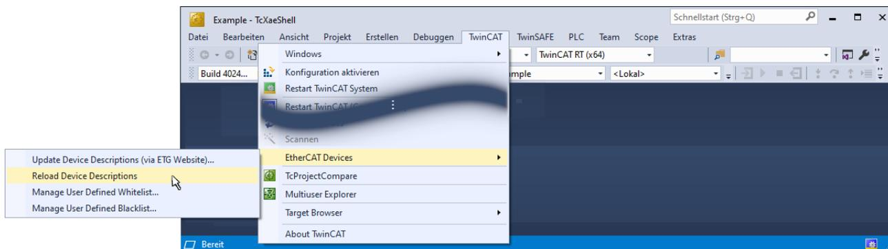
Der Status des Cache-Neuaufbaus ist in der unteren Statusleiste in TwinCAT zu sehen.
