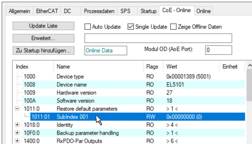
Abb. 178: Auswahl des PDO *Restore default parameters*
