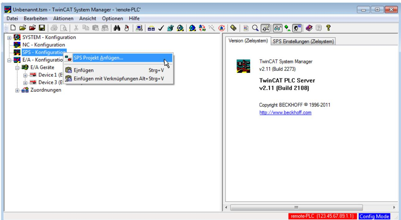
Abb. 52: Hinzufügen des Projektes des TwinCAT PLC Control
