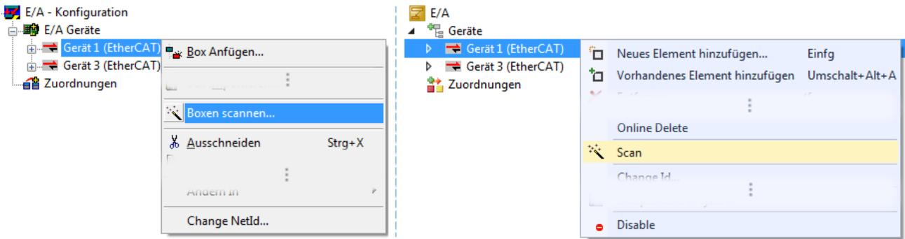
Abb. 119: Manuelles Scannen nach Teilnehmern auf festgelegtem EtherCAT Device (links: TC2; rechts TC3)
