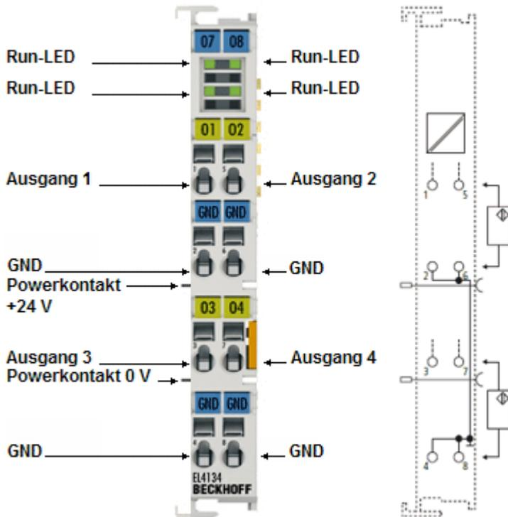
Abb. 19: LED und Anschlussbelegung EL4134-00xx
