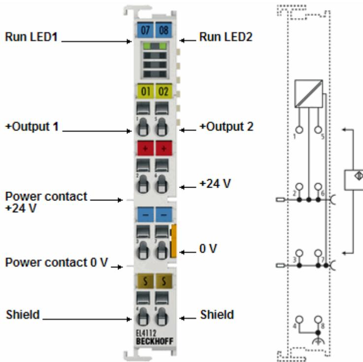
Abb. 9: LED und Anschlussbelegung EL4112-00xx
