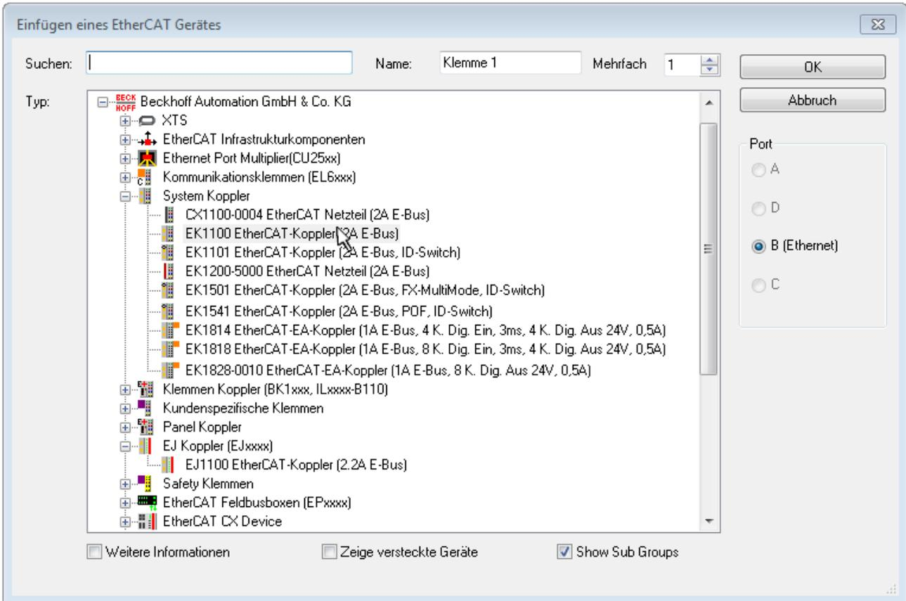
Abb. 106: Auswahldialog neues EtherCAT-Gerät
