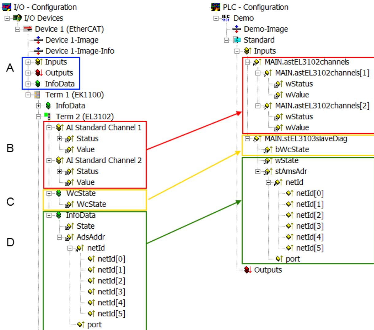
Abb. 143: Grundlegende EtherCAT-Slave Diagnose in der PLC
