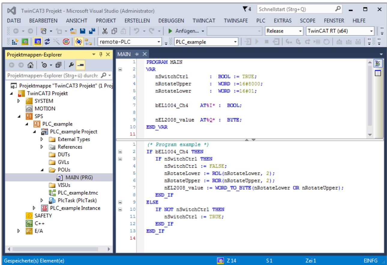
Abb. 72: Beispielprogramm mit Variablen nach einem Kompilervorgang (ohne Variablenanbindung)
