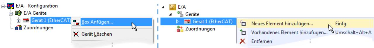
Abb. 105: Anfügen von EtherCAT-Geräten (links: TwinCAT 2; rechts: TwinCAT 3)
