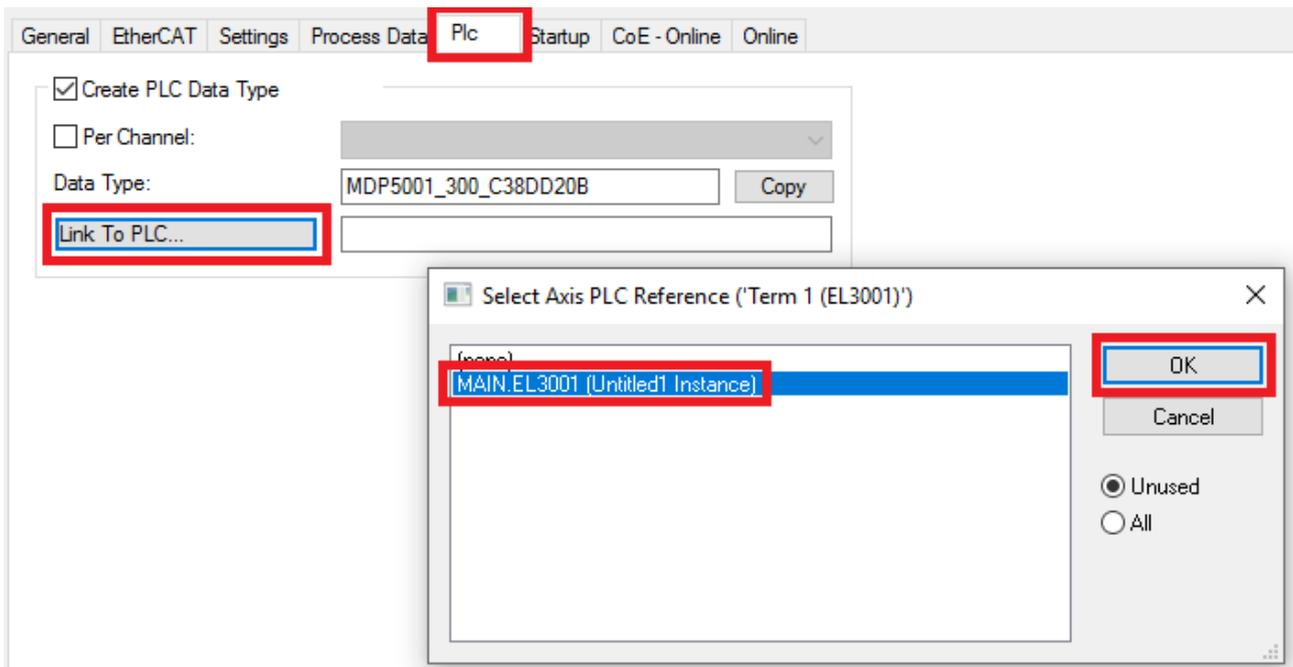
Abb. 80: Verknüpfung der Struktur
