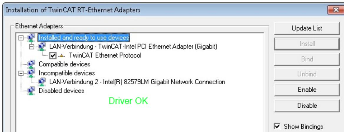
Abb. 89: Beispielhafte korrekte Treiber-Einstellung des Ethernet Ports
