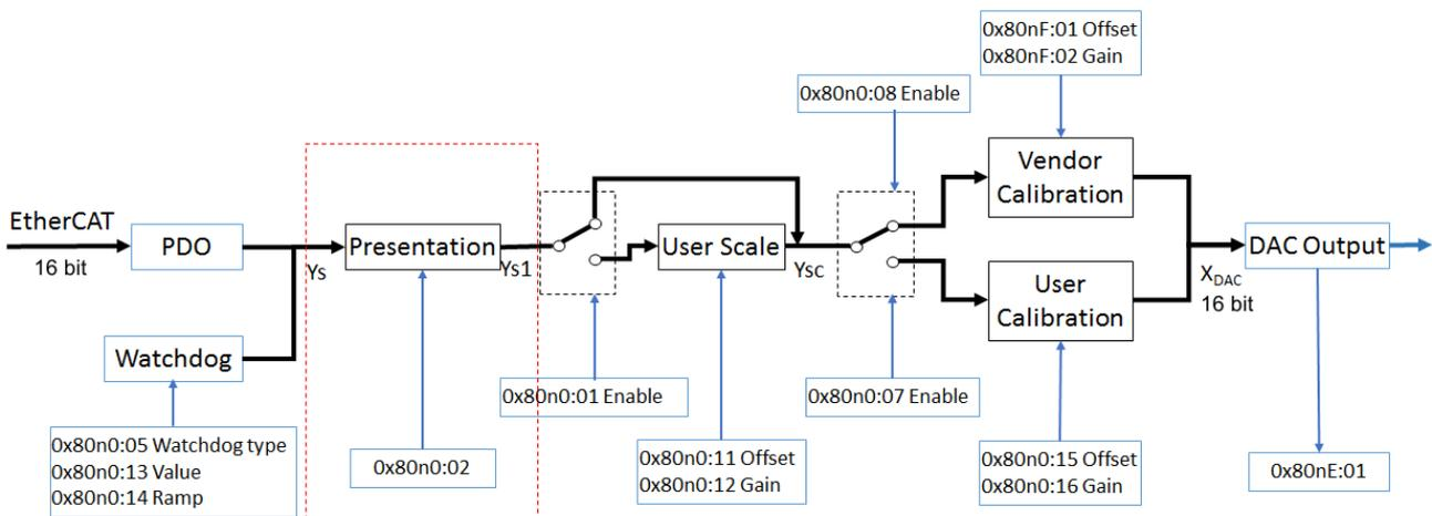
Abb. 152: Blockschaltbild zur Bestimmung der Ausgabewerte mit Default-Einstellungen (Funktion Darstellung)
