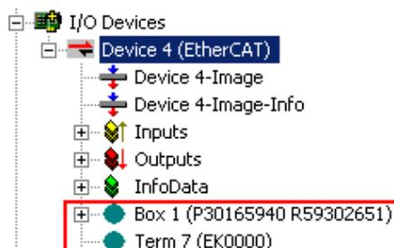
Abb. 125: Fehlerhafte Erkennung
