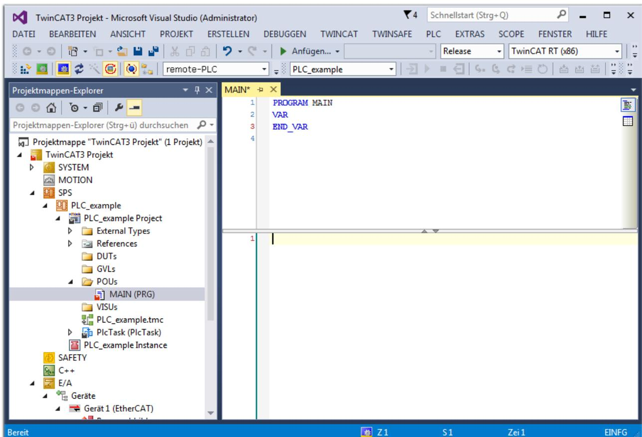
Abb. 71: Initiales Programm „Main“ des Standard PLC Projektes
