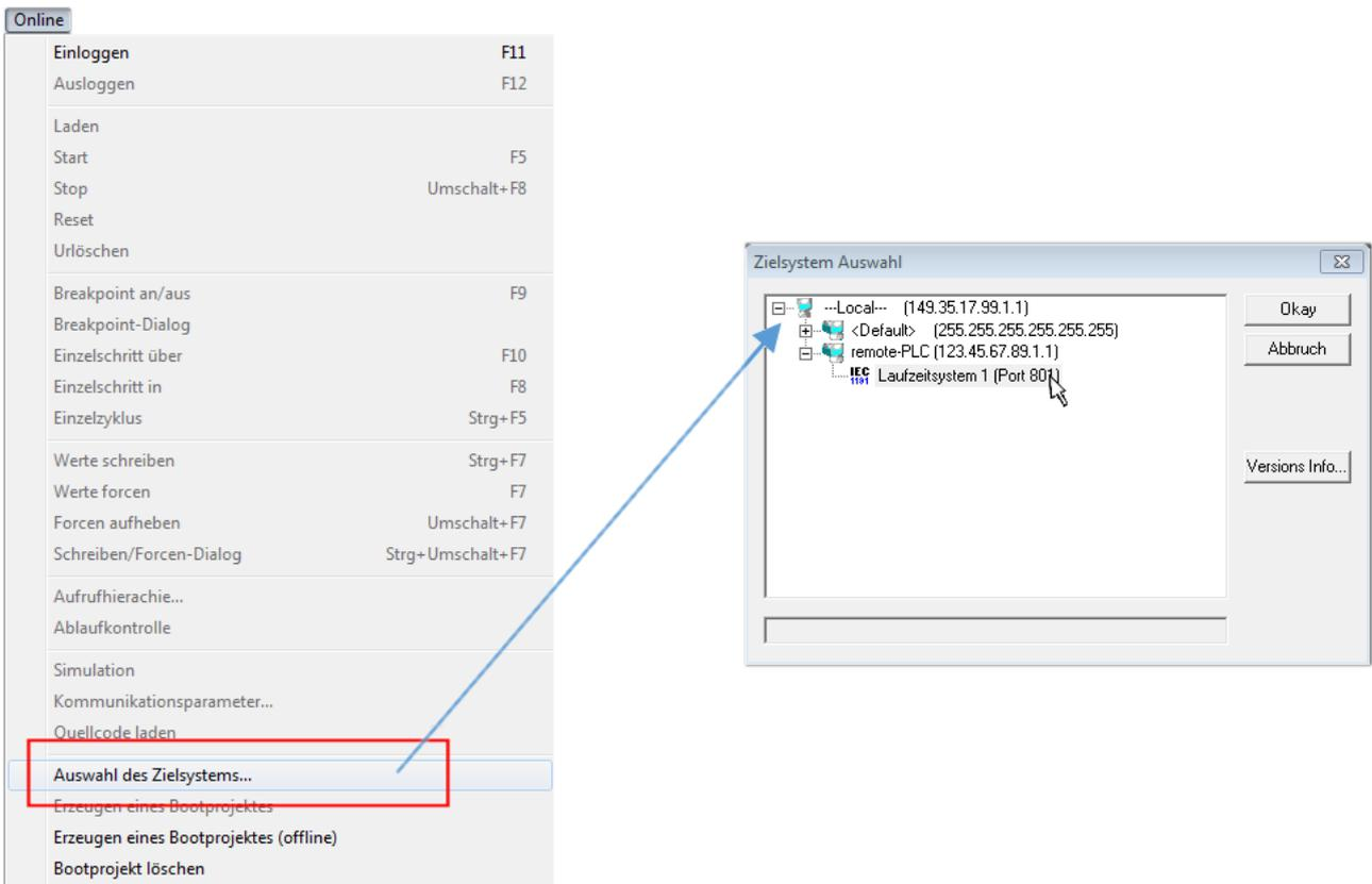
Abb. 58: Auswahl des Zielsystems (remote)
