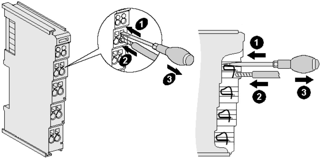
Abb. 40: Anschluss einer Leitung an eine Klemmstelle
