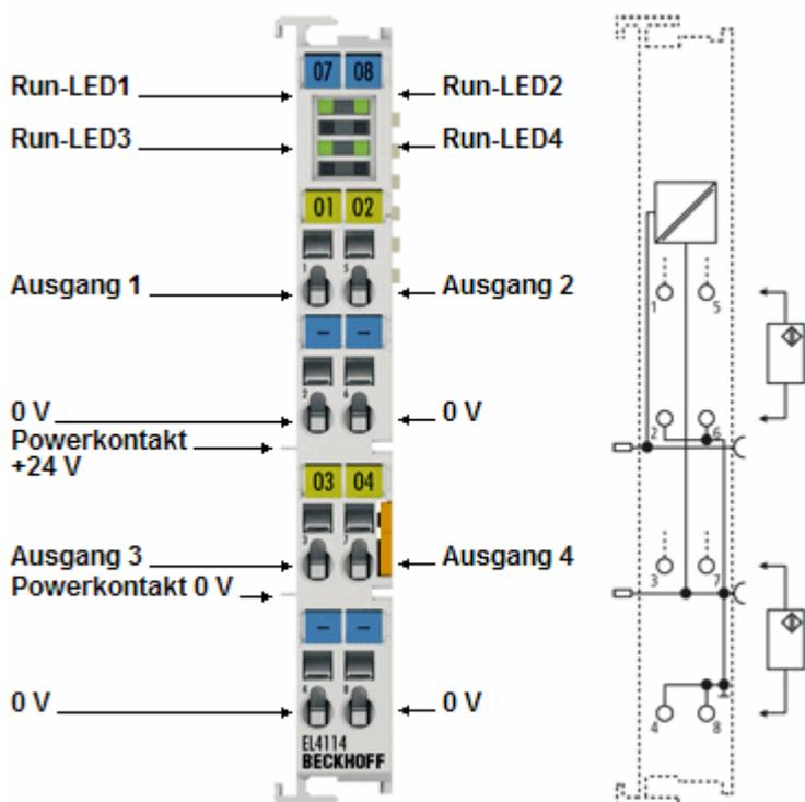
Abb. 11: LED und Anschlussbelegung EL4114-xxxx
