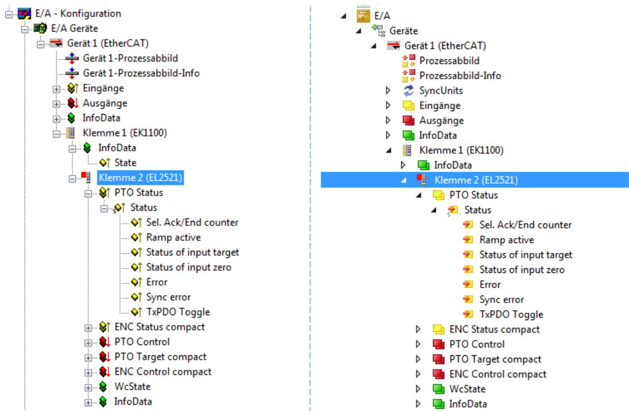
Abb. 110: EtherCAT Klemme im TwinCAT-Baum (links: TwinCAT 2; rechts: TwinCAT 3)
