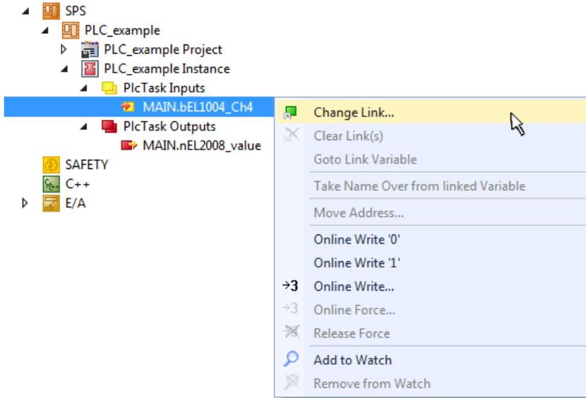
Abb. 74: Erstellen der Verknüpfungen PLC-Variablen zu Prozessobjekten
