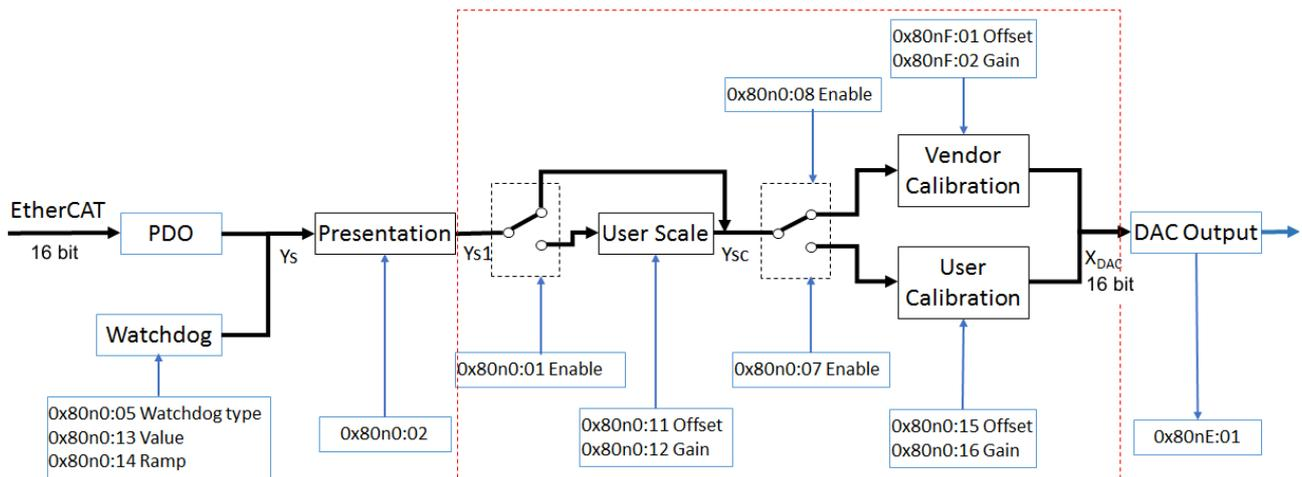
Abb. 153: Blockschaltbild zur Bestimmung der Ausgabewerte in Default-Einstellung (Funktion Gain/Offset)
