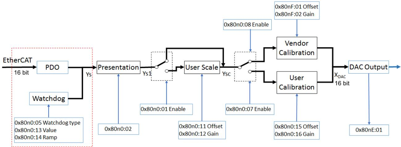
Abb. 158: Blockschaltbild zur Bestimmung der Ausgabewerte in Default-Einstellung (Funktion Watchdog)
