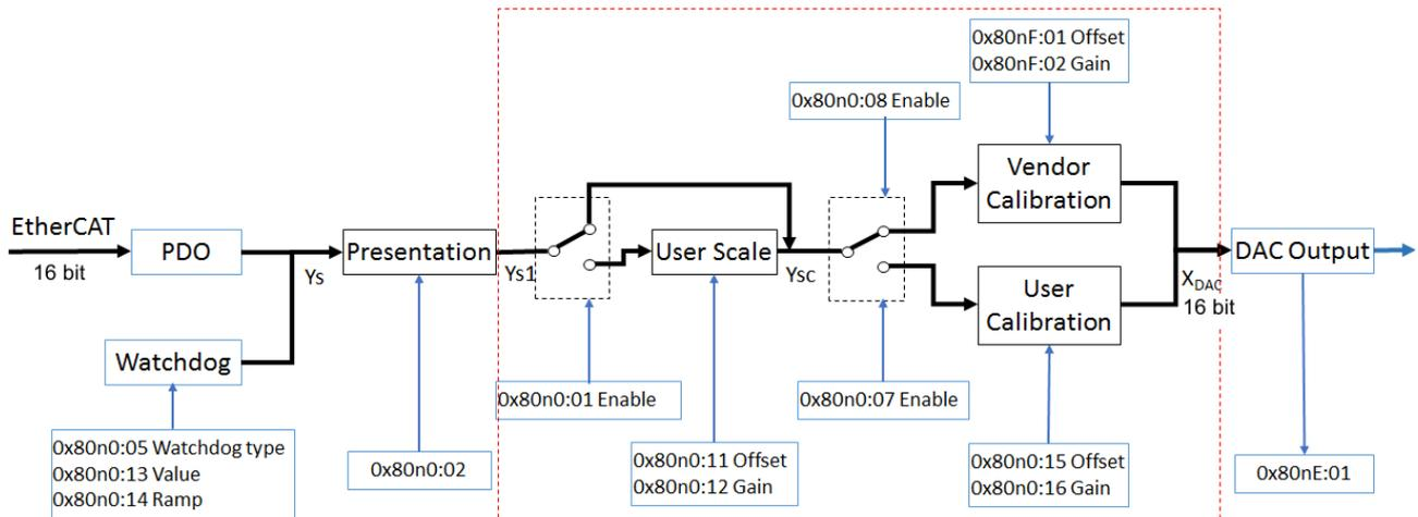
Abb. 157: Blockschaltbild zur Bestimmung der Ausgabewerte in Default-Einstellung (Funktion Gain/Offset)
