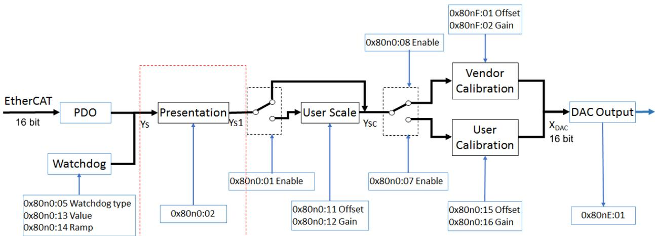
Abb. 156: Blockschaltbild zur Bestimmung der Ausgabewerte mit Default-Einstellungen (Funktion Darstellung)
