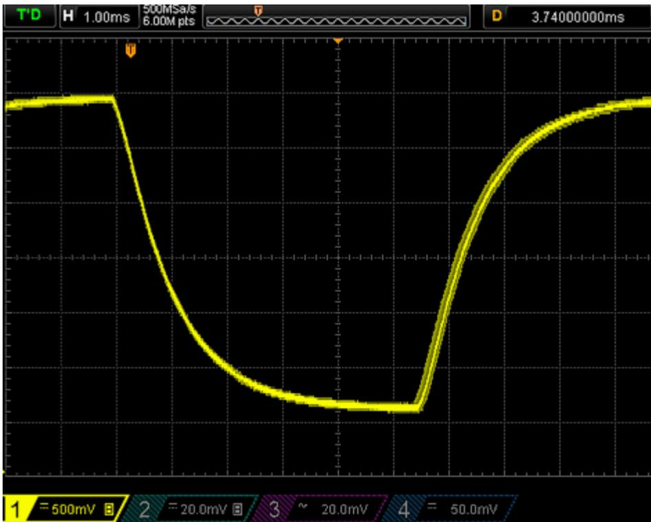
Abb. 147: EL4078 mit 500 µs EtherCAT Zykluszeit, Ausgabejitter der Theorie entsprechend  $\pm 0,5$  Zyklus
