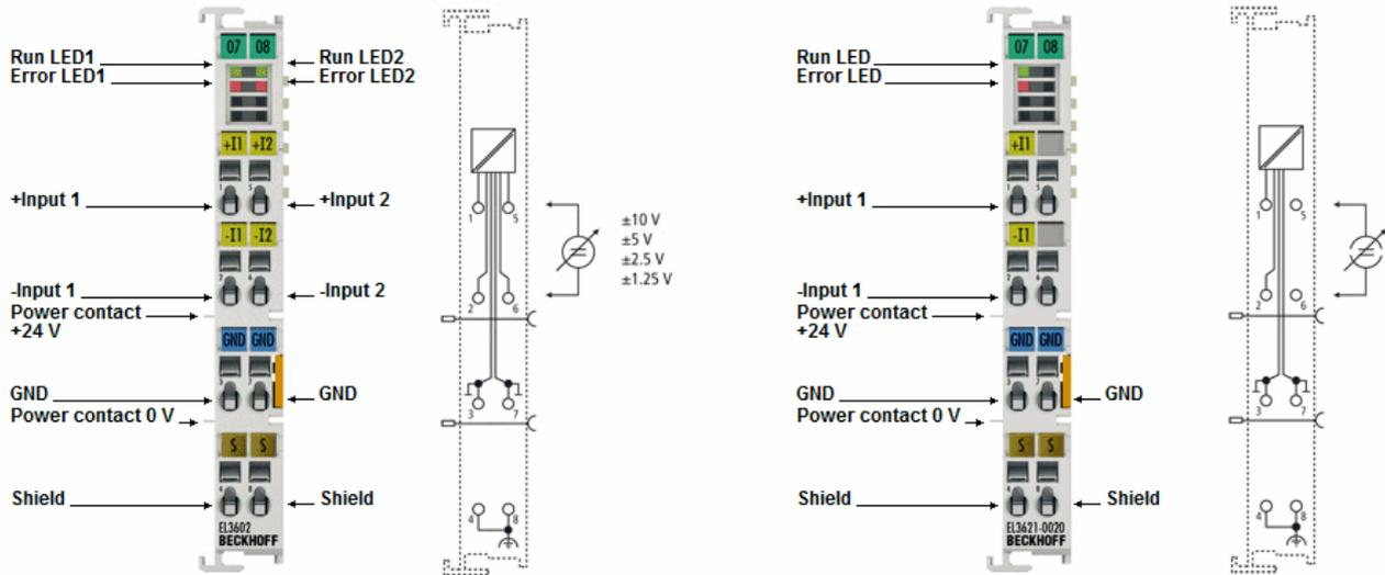
Abb. 28: Anschlussbelegung am Beispiel EL3602 (2 Kanal)/ EL3621-0020 (1 Kanal)
