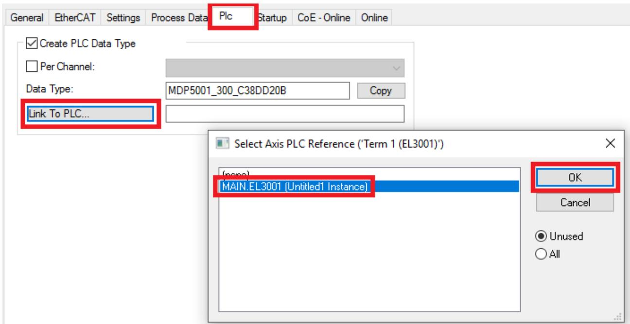
Abb. 71: Verknüpfung der Struktur
