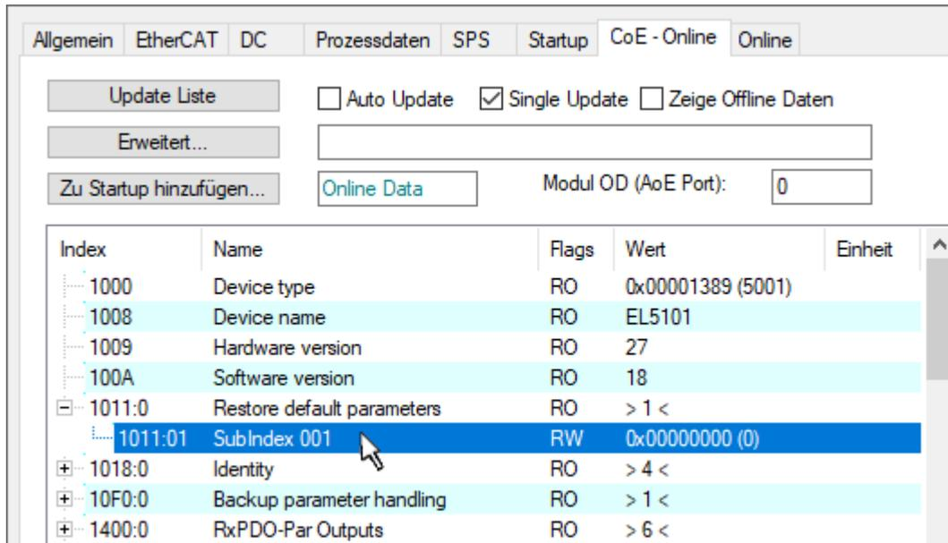
Abb. 155: Auswahl des PDO *Restore default parameters*
