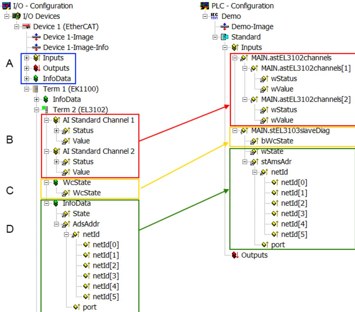
Abb. 134: Grundlegende EtherCAT-Slave Diagnose in der PLC
