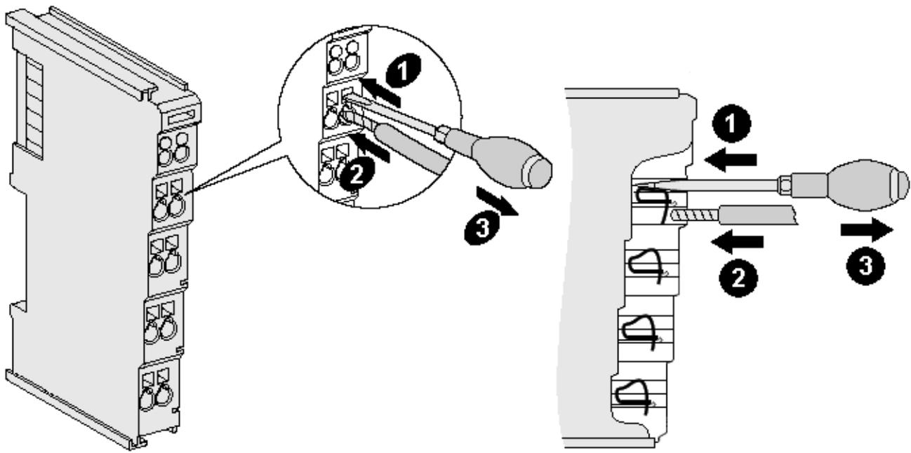
Abb. 24: Anschluss einer Leitung an eine Klemmstelle
