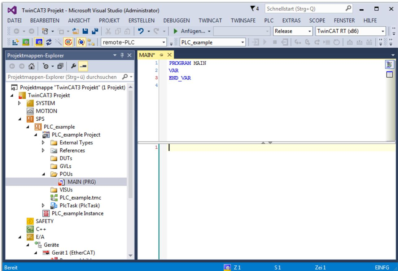
Abb. 62: Initiales Programm „Main“ des Standard PLC Projektes
