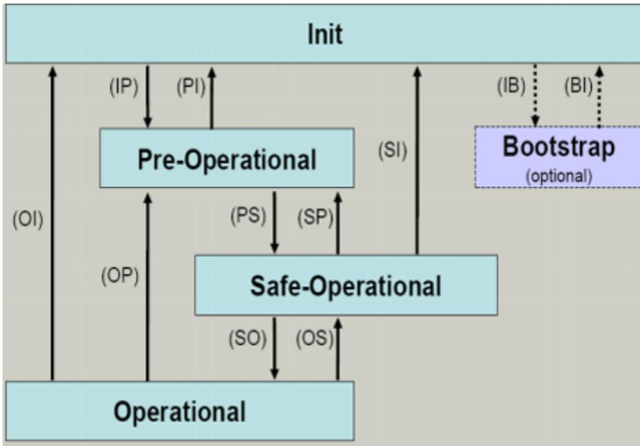
Abb. 9: Zustände der EtherCAT State Machine
