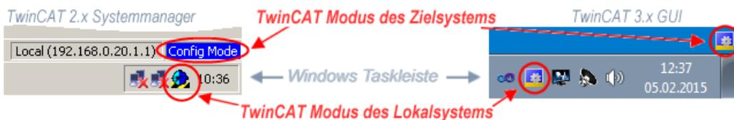
Abb. 98: Unterscheidung Lokalsystem/ Zielsystem (links: TwinCAT 2; rechts: TwinCAT 3)
