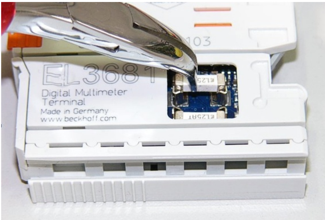
Abb. 159: Austausch der Sicherung
