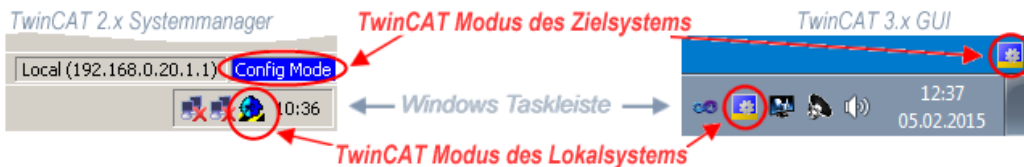
Abb. 96: Unterscheidung Lokalsystem/ Zielsystem (links: TwinCAT 2; rechts: TwinCAT 3)
