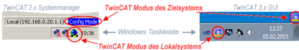
Abb. 99: Unterscheidung Lokalsystem/ Zielsystem (links: TwinCAT 2; rechts: TwinCAT 3)
