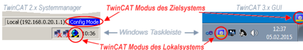
Abb. 102: Unterscheidung Lokalsystem/ Zielsystem (links: TwinCAT 2; rechts: TwinCAT 3)
