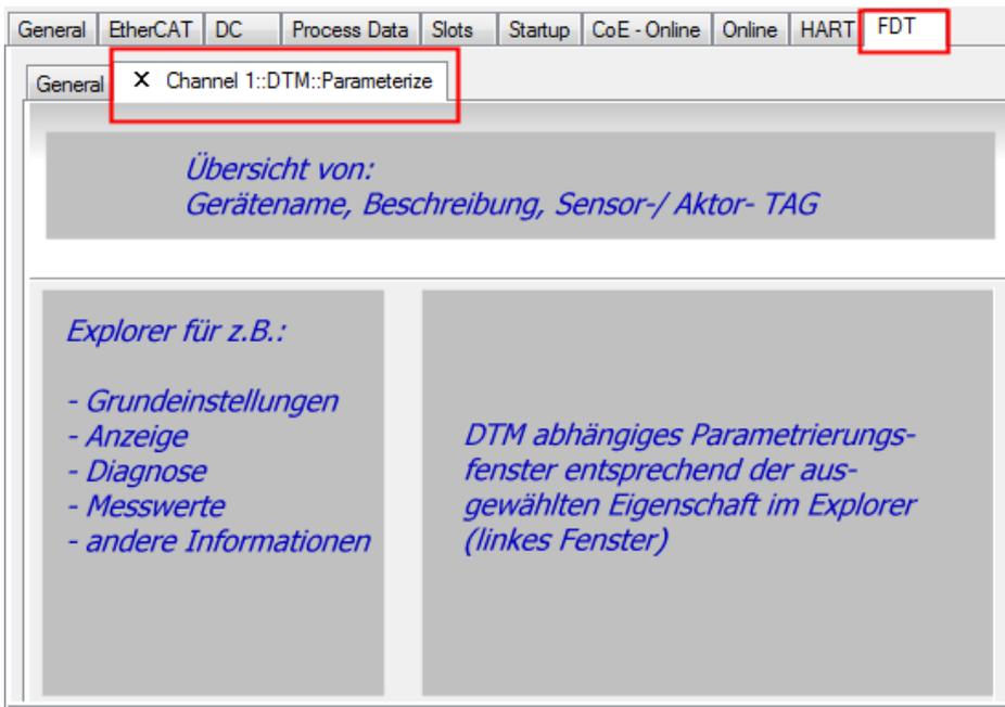
Abb. 115: Allgemeiner Aufbau eines DTM-Konfigurationsfensters innerhalb des Field Device Tools (FDT)
