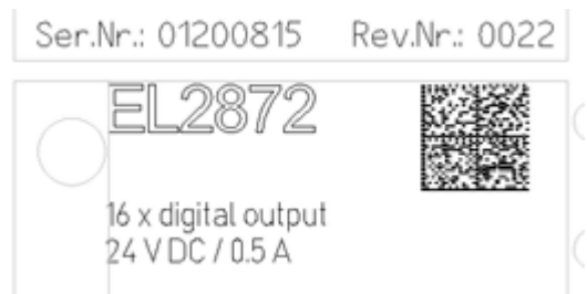
Abb. 1: EL2872 mit Revision 0022 und Seriennummer 01200815
