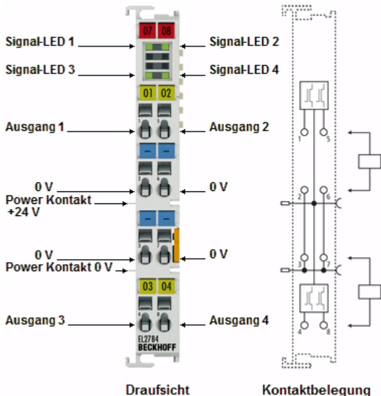
Abb. 5: EL2784 - LEDs und Anschlussbelegung
