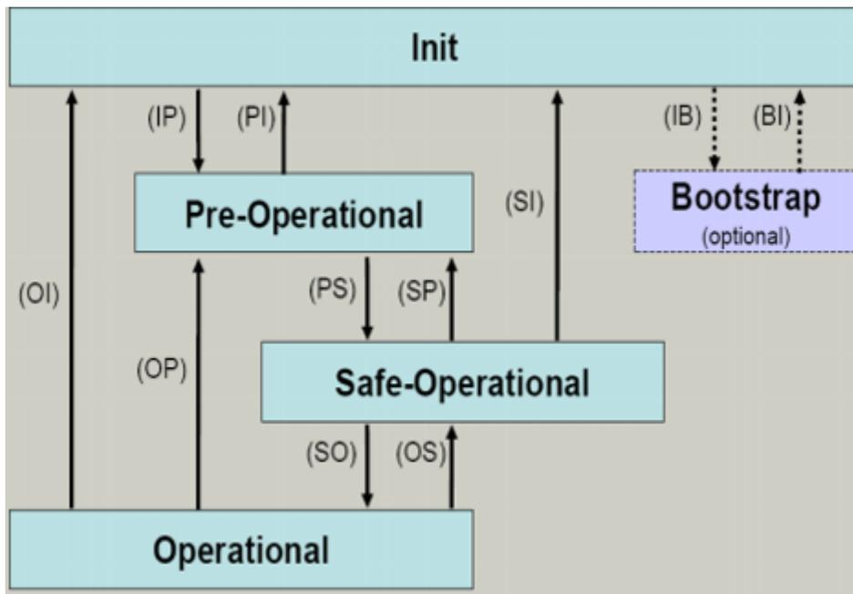
Abb. 14: Zustände der EtherCAT State Machine
