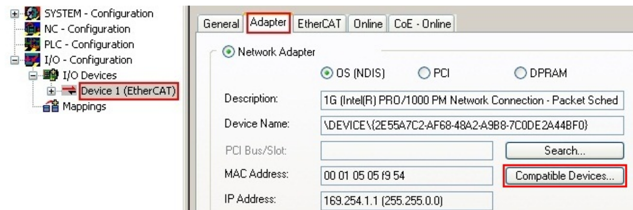
附图 43: EtherCAT 设备属性（TwinCAT 2）：点击“Adapter”选项卡的“Compatible Devices...”
