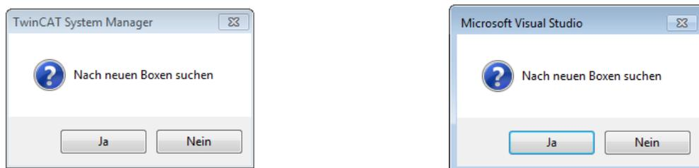
Abb. 102: Scan-Abfrage nach automatischem Anlegen eines EtherCAT-Gerätes (links: TC2; rechts TC3)
